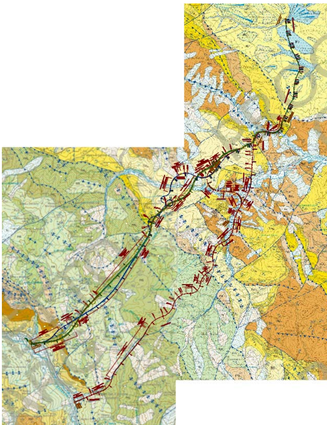
Figura 3-1 - Stralcio cartografia geologica ufficiale CARG dell'ISPRA, ottenuto dall'unione dei fogli 470 "Potenza" e 471 "Irsina", con riportate le alternative di tracciato oggetto di studio.
