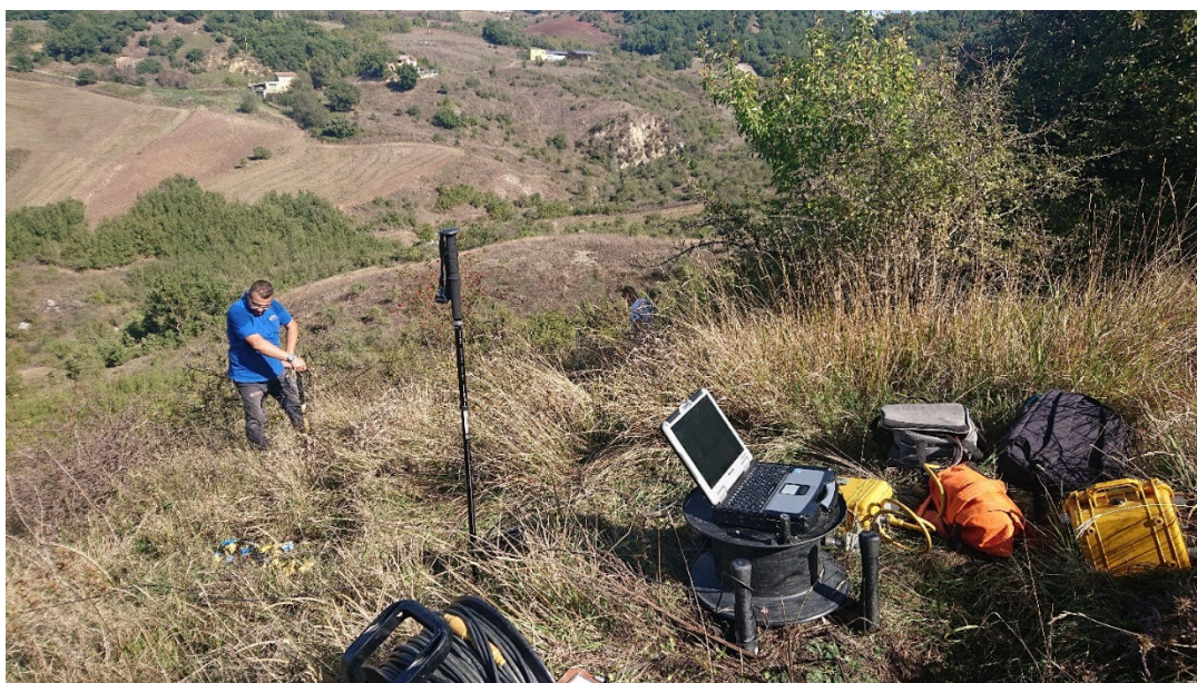
Acquisizione delle misure di sismica a rifrazione SR01
