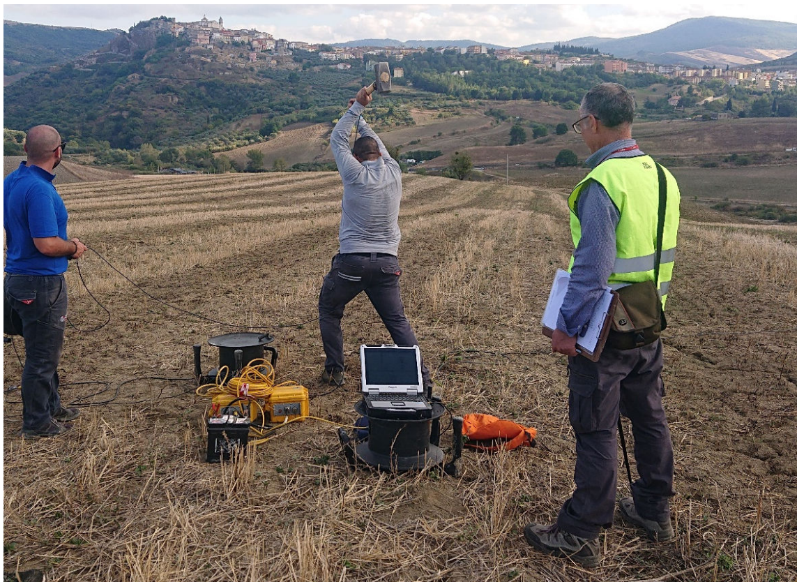
Acquisizione dati indagine sismica a rifrazione SR03
