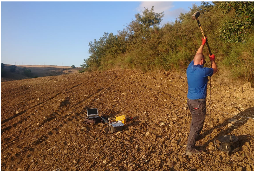
Acquisizione dati indagine sismica Masw MW03
