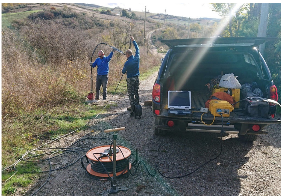
DH-S2. Inserimento della doppia terna di sensori nel foro.
