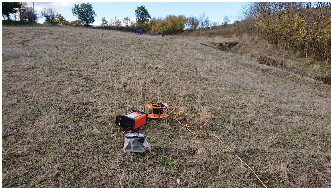
Acquisizione dati profilo geoelettrico TE05
