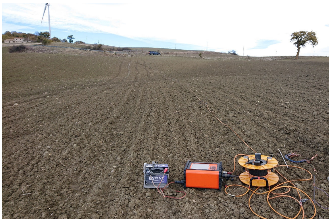
Acquisizione dati profilo geoelettrico TE04
