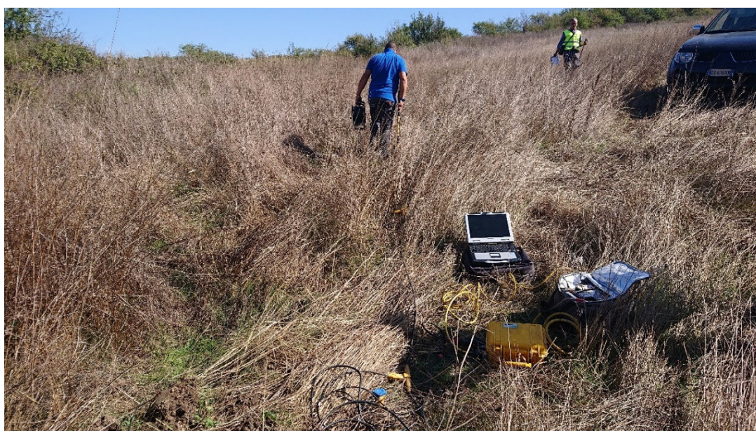
Acquisizione delle misure di sismica MASW Mw01
