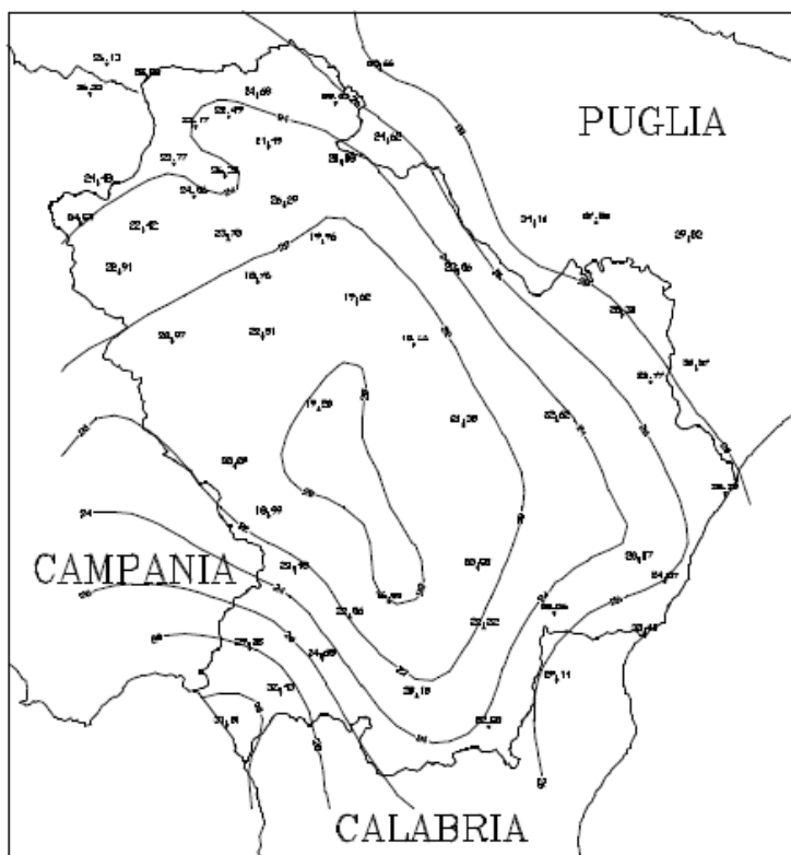
Figura 4.2 – Iso linee del coefficiente a' della curva di probabilità pluviometrica
