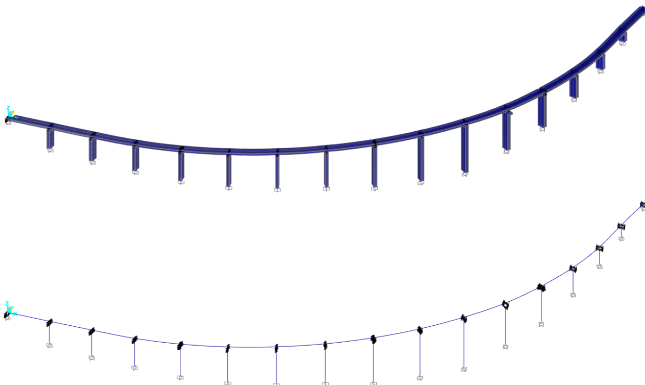
Figura 7.2 Modello FEM: Vista prospettica modello, estrusa (in alto) e wireframe
