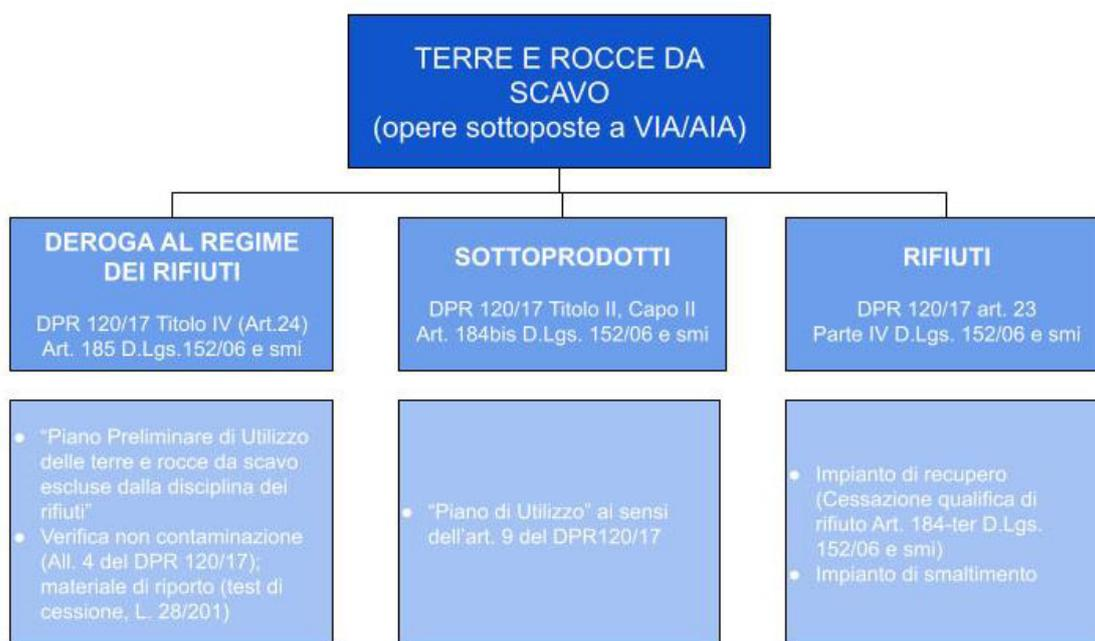
Nel progetto si riscontrano due possibili modalità di gestione del materiale da scavo:
