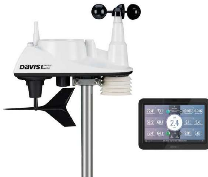
Figura 15: Stazione meteo portatile di altezza media 1,5 s.l.t. per il monitoraggio dei parametri anemologici di sito durante l'indagine fonometrica.
