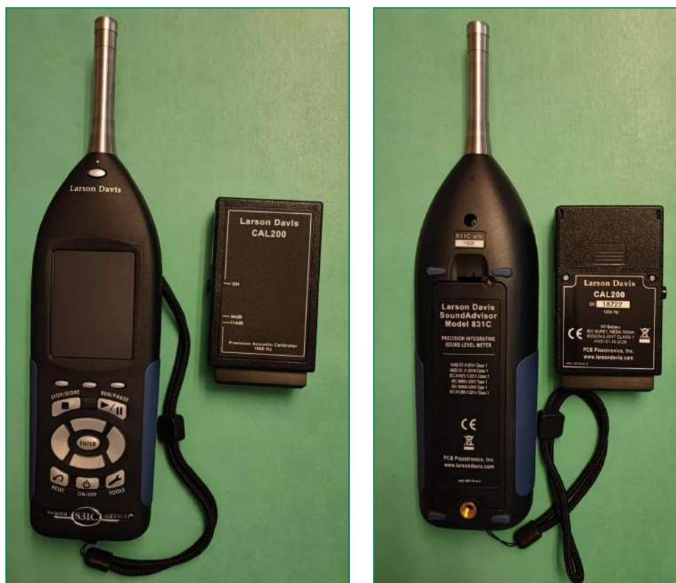
Figura 14: Strumentazione utilizzata per indagine acustica; fonometro e calibratore.
