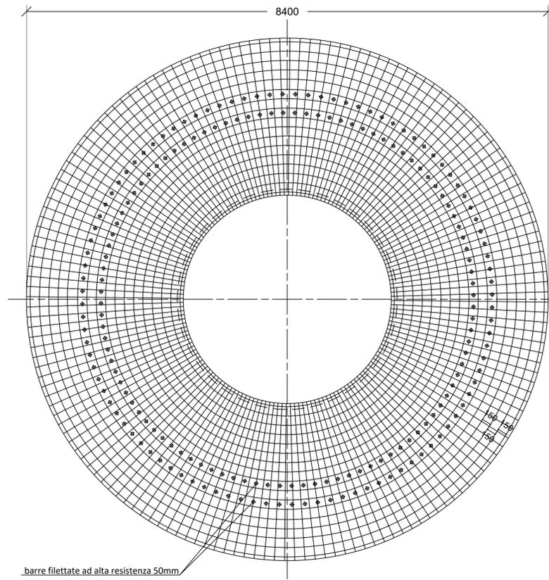
ARMATURA RADIALE SUPERIORE DELLA FONDAZIONE - SCALA 1:100
