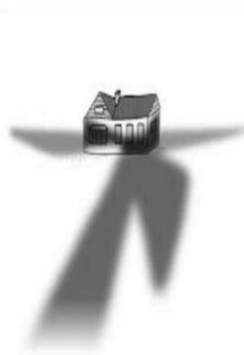
Figura 28 - Esempio grafico del potenziale effetto di ombreggiamento di un aerogeneratore nei confronti di un edificio
