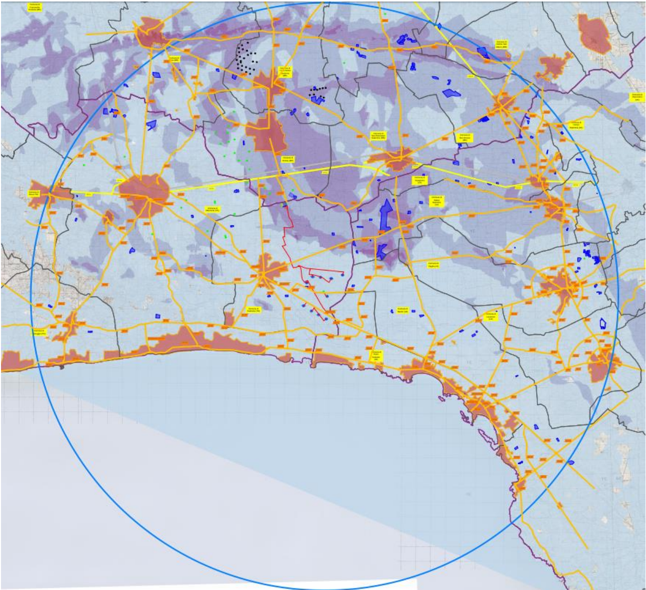
Figura 116 – Mappa dell'intervisibilità teorica dell'impianto eolico di progetto con impianti esistenti e autorizzati (Rif. EO_AVT01_PD_PAES_05_00)
