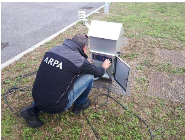
**Figura 4 - Esempio di campionatore per il monitoraggio della qualità dell'aria (Fonte: Arpa Lombardia)**
