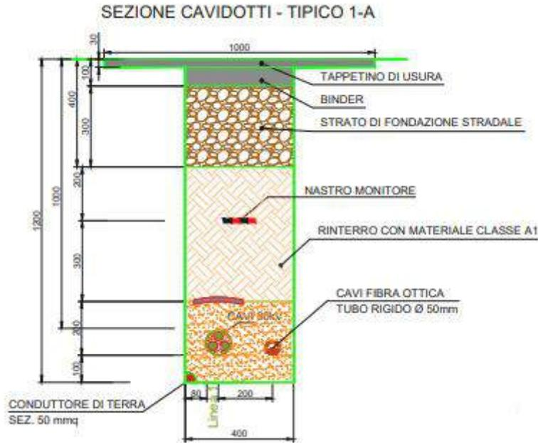
*Figura 44 – Sezione di scavo MT su strada asfaltata*
