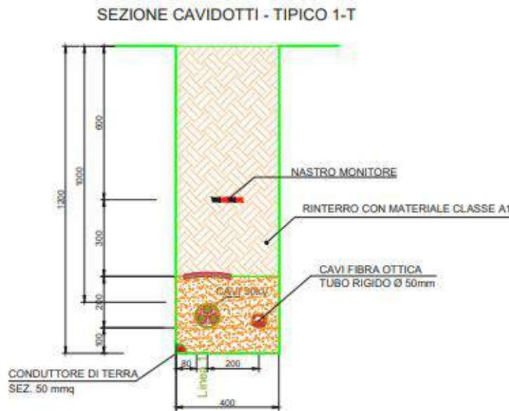
Figura 46 – Sezione di scavo Cavo MT + cavo segnale e corda di rame su terreno
