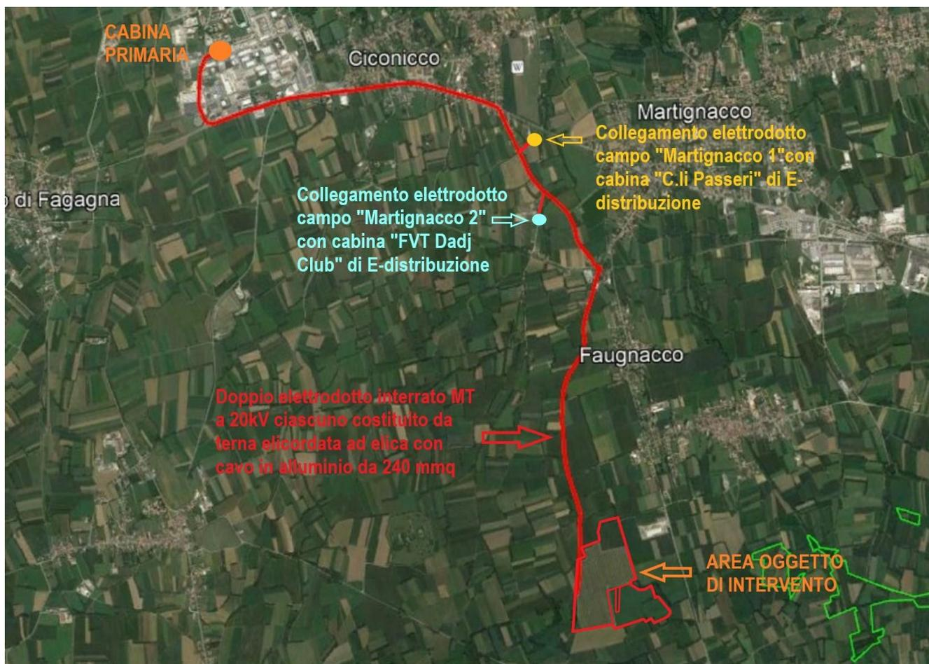
*Vista d'insieme dell'impianto di connessione con collegamento cavi MT interrati su base ortofoto*
