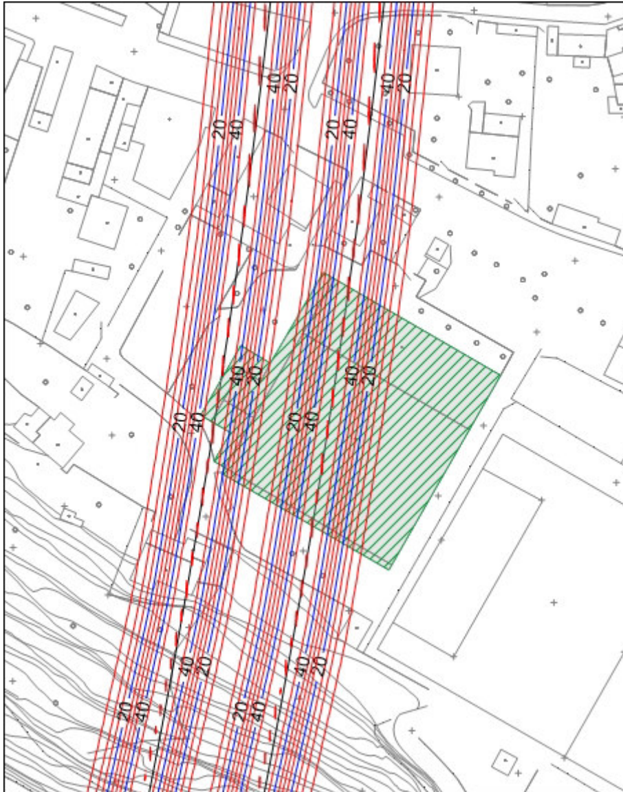
Figura 46: isolinee dei cedimenti w (in mm) – 14° tratto della canna pari – V_L=0,4\%
