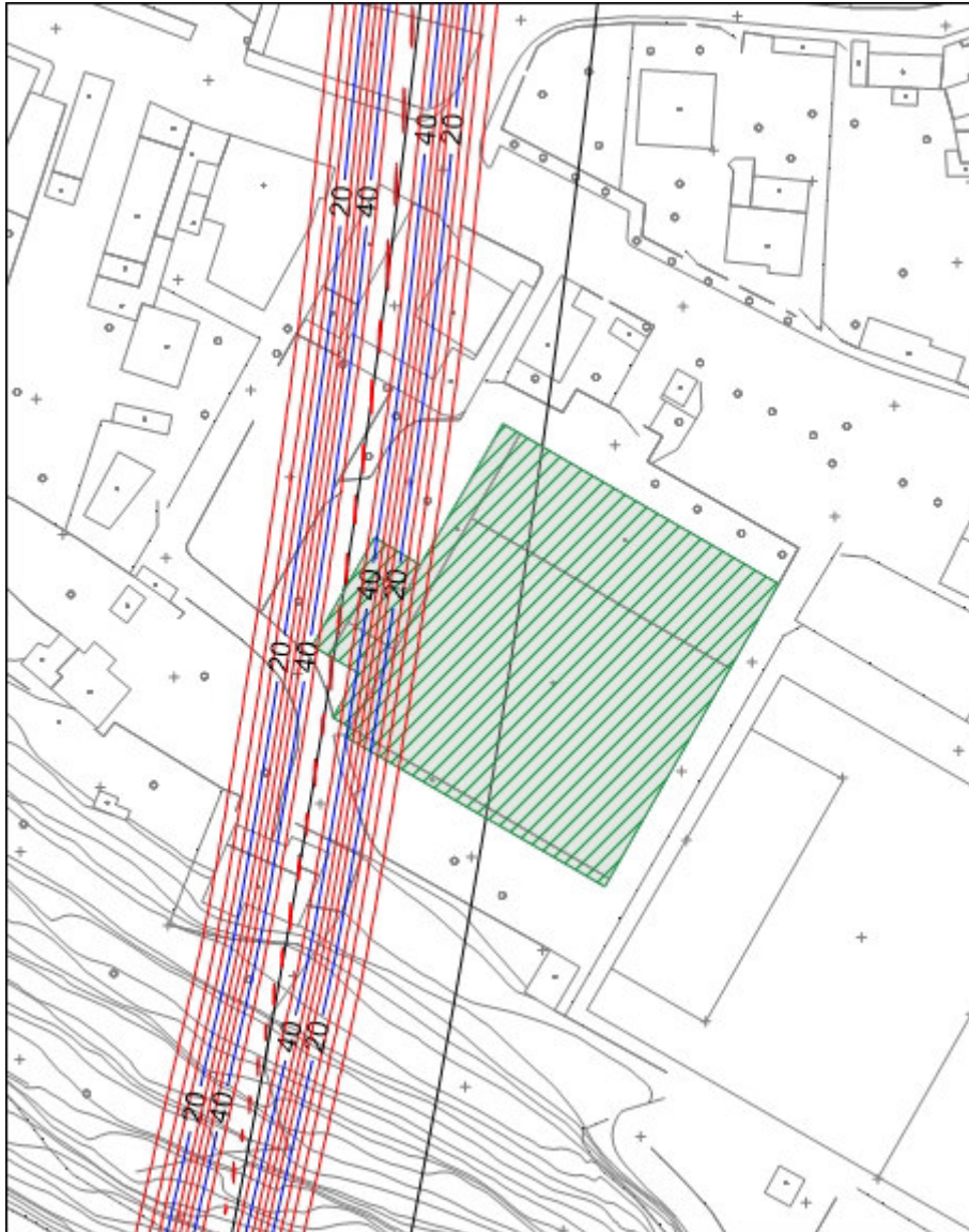
Figura 39: isolinee dei cedimenti w (in mm) – 7° tratto della canna dispari – V_L=0,4\%
