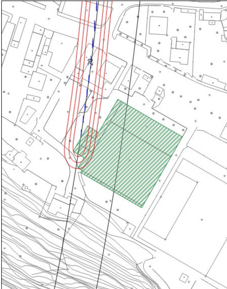
Figura 22: isolinee dei cedimenti w (in mm) – 4° tratto della canna dispari – V_L=0,4\%
