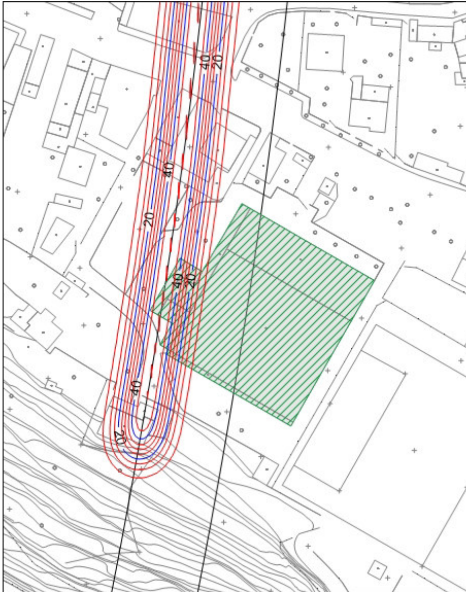
Figura 38: isolinee dei cedimenti w (in mm) – 6° tratto della canna dispari – V_L=0,4\%
