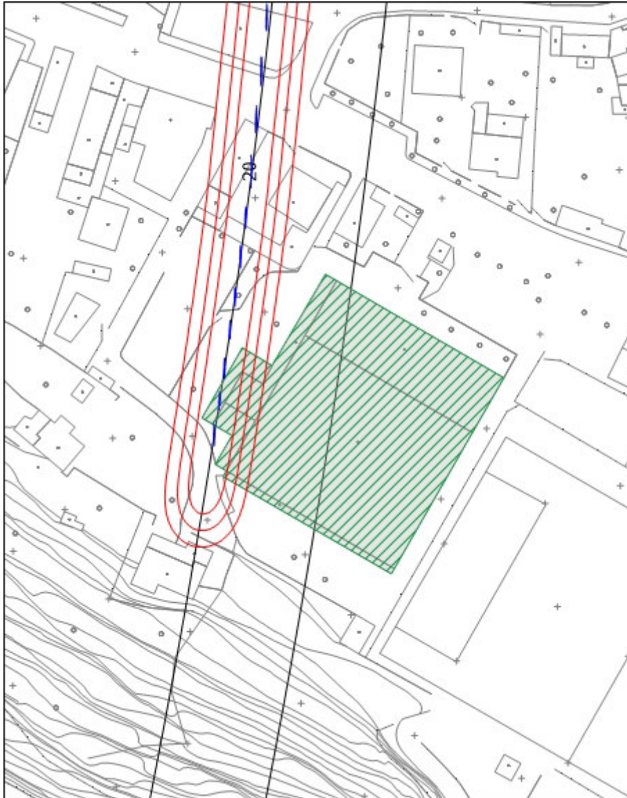
Figura 23: isolinee dei cedimenti w (in mm) – 5° tratto della canna dispari – V_L=0,4\%
