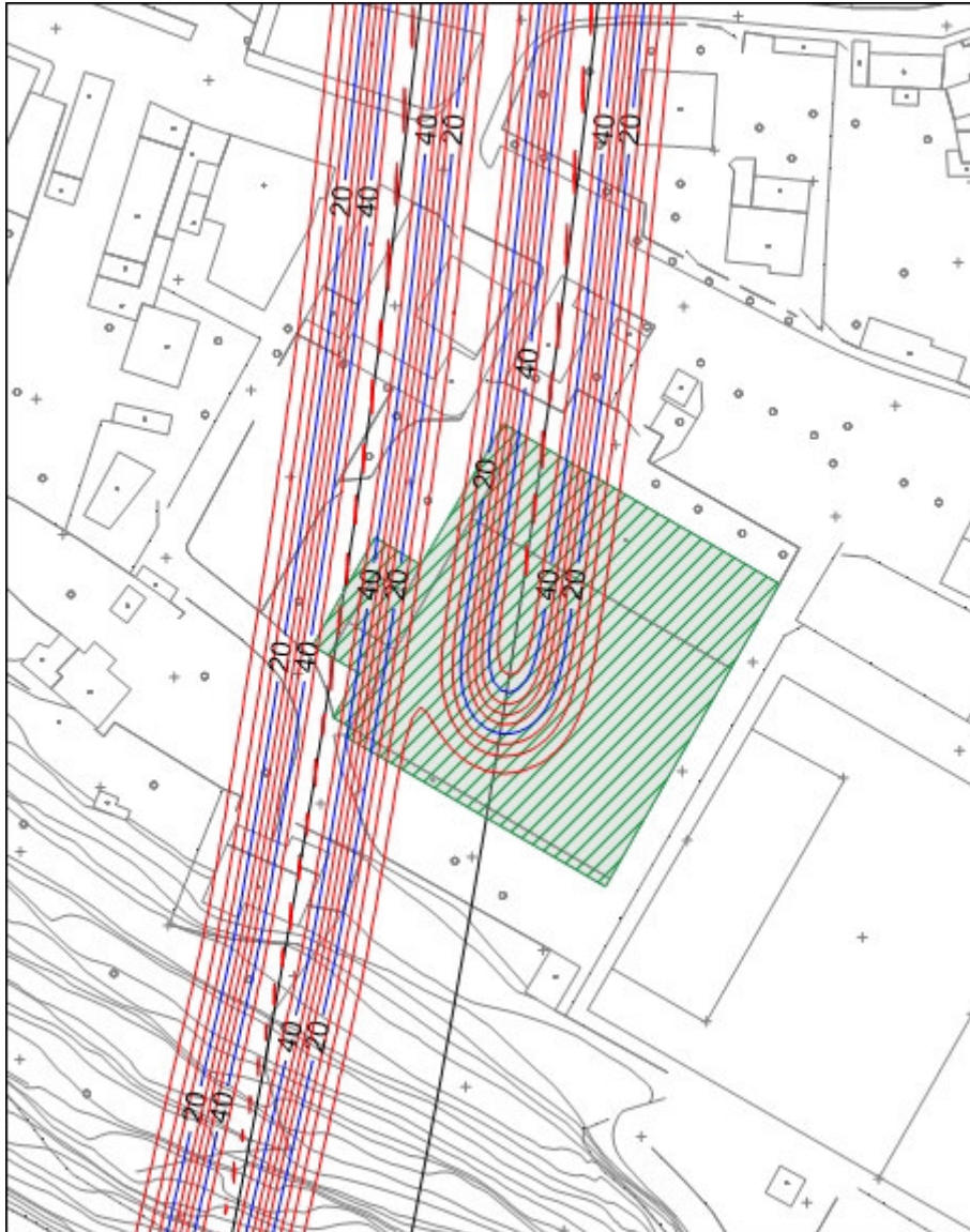
Figura 43: isolinee dei cedimenti w (in mm) – 11° tratto della canna pari – V_L=0,4\%
