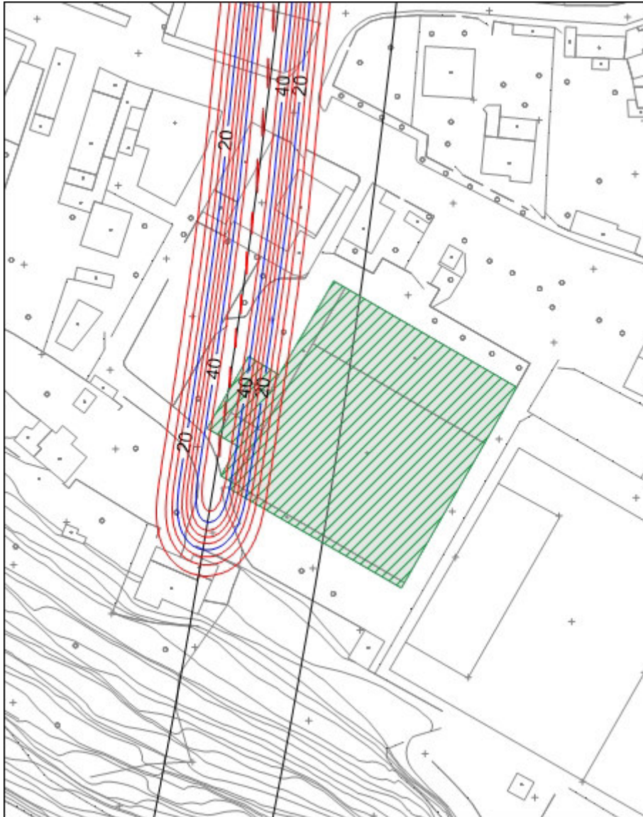
Figura 37: isolinee dei cedimenti w (in mm) – 5° tratto della canna dispari – V_L=0,4\%
