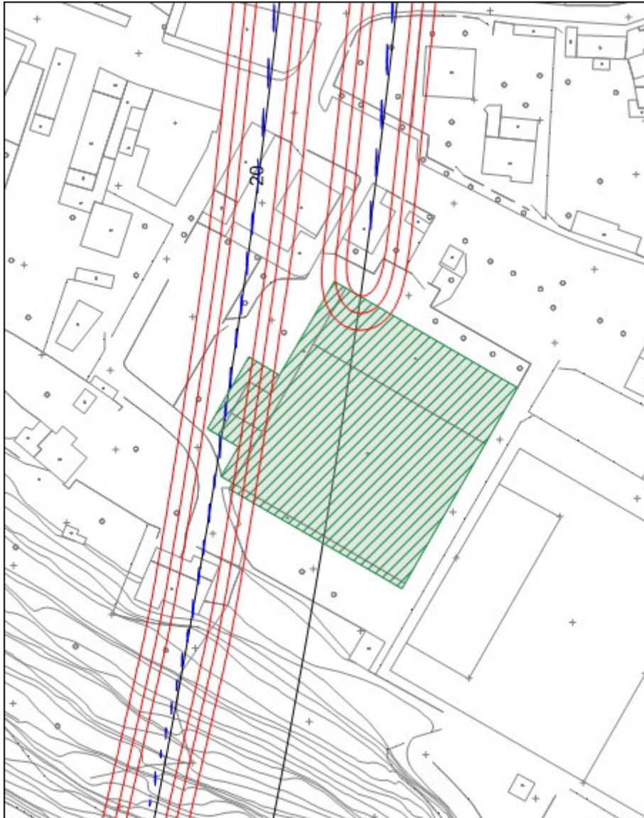
Figura 27: isolinee dei cedimenti w (in mm) – 9° tratto della canna pari – V_L=0,4\%
