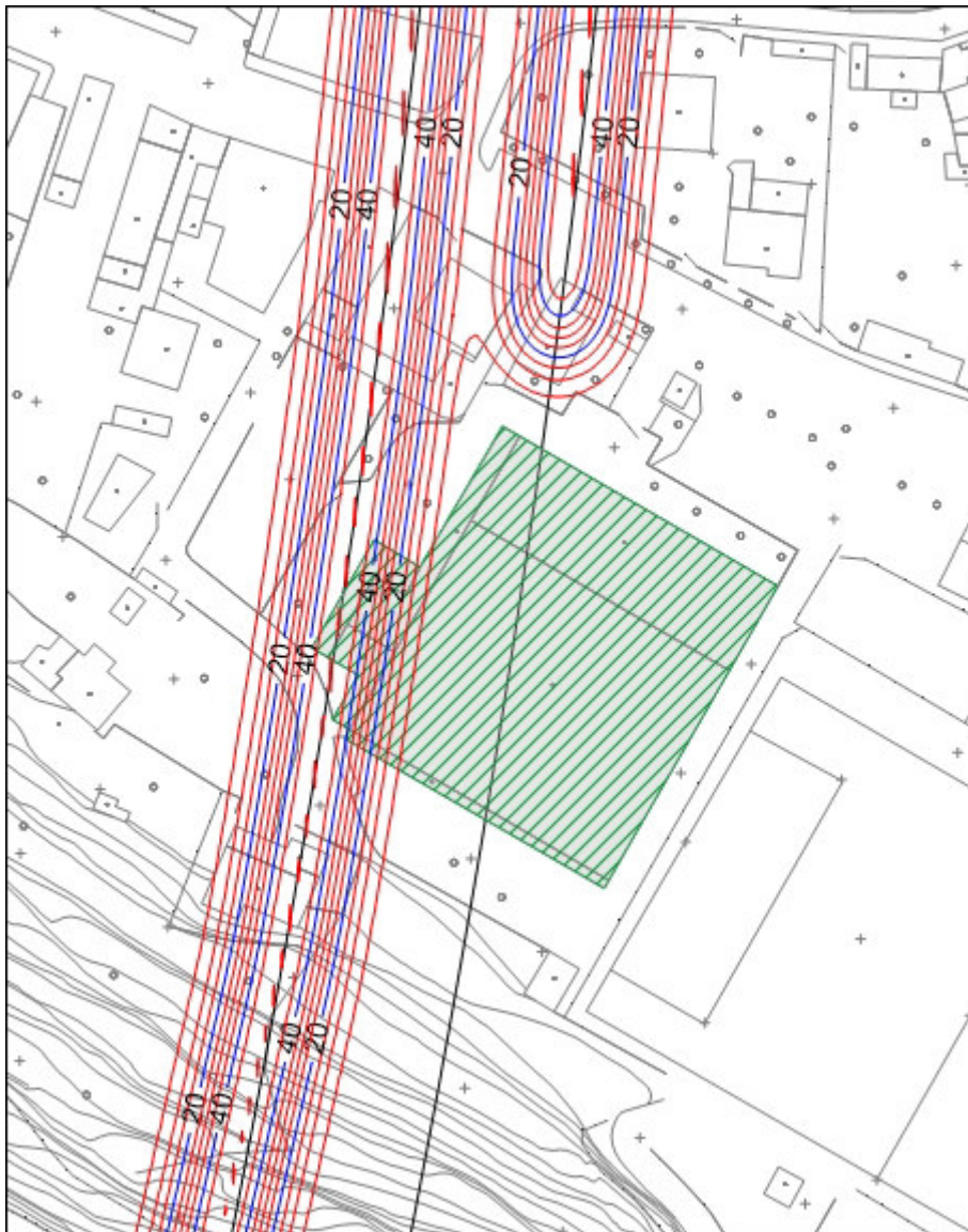
Figura 40: isolinee dei cedimenti w (in mm) – 8° tratto della canna pari – V_L=0,4\%
