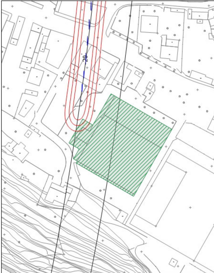
Figura 21: isolinee dei cedimenti w (in mm) – 3° tratto della canna dispari – V_L=0,4\%
