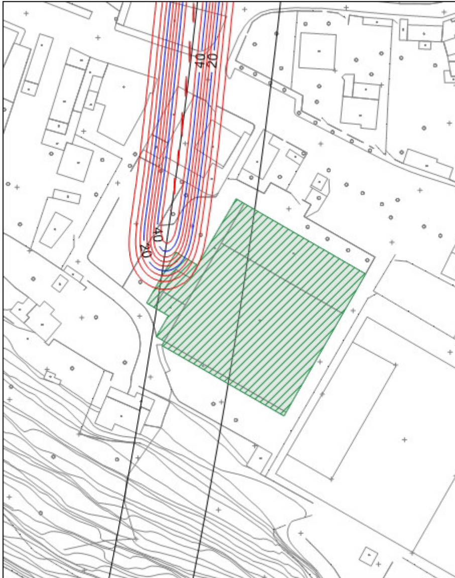
Figura 35: isolinee dei cedimenti w (in mm) – 3° tratto della canna dispari – V_L=0,4\%
