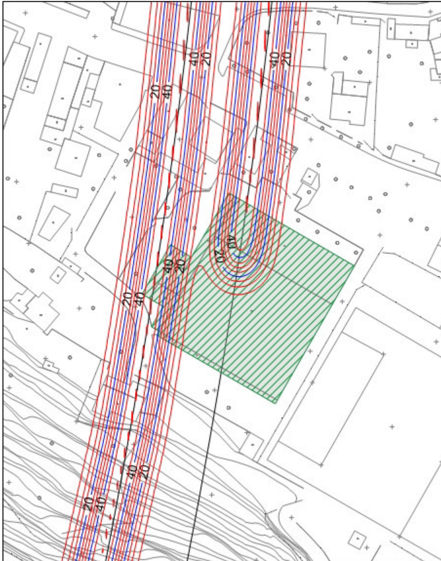
Figura 42: isolinee dei cedimenti w (in mm) – 10° tratto della canna pari – V_L=0,4\%
