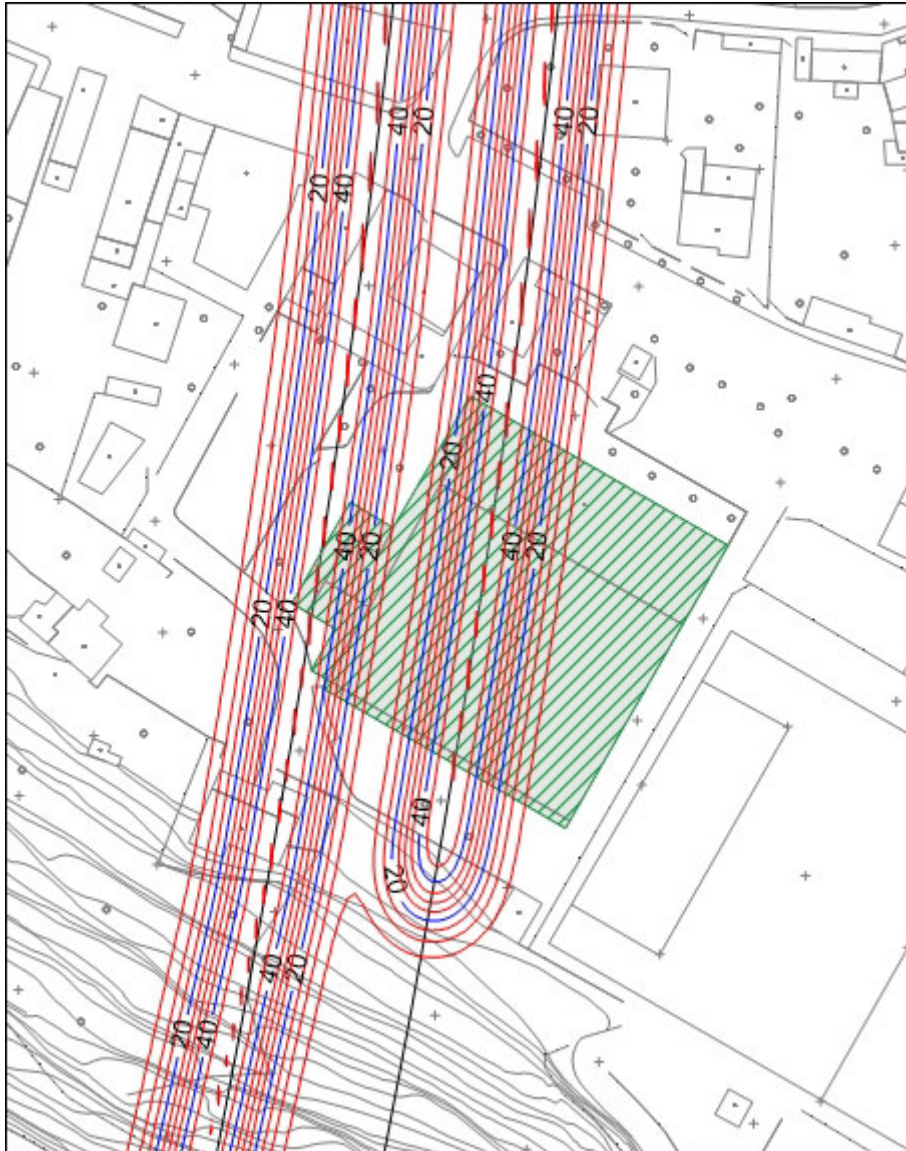
Figura 45: isolinee dei cedimenti w (in mm) – 13° tratto della canna pari – V_L=0,4\%
