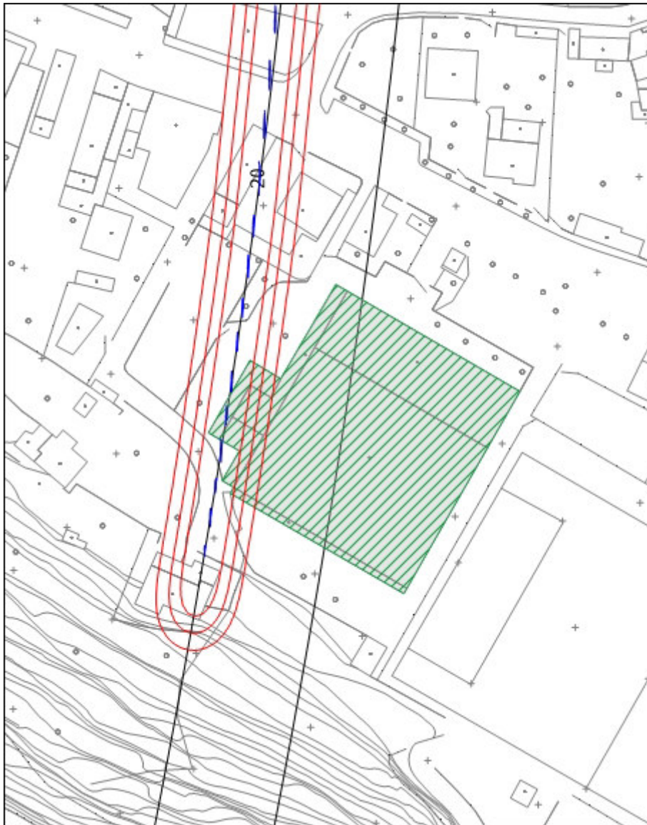
Figura 24: isolinee dei cedimenti w (in mm) – 6° tratto della canna dispari – V_L=0,4\%
