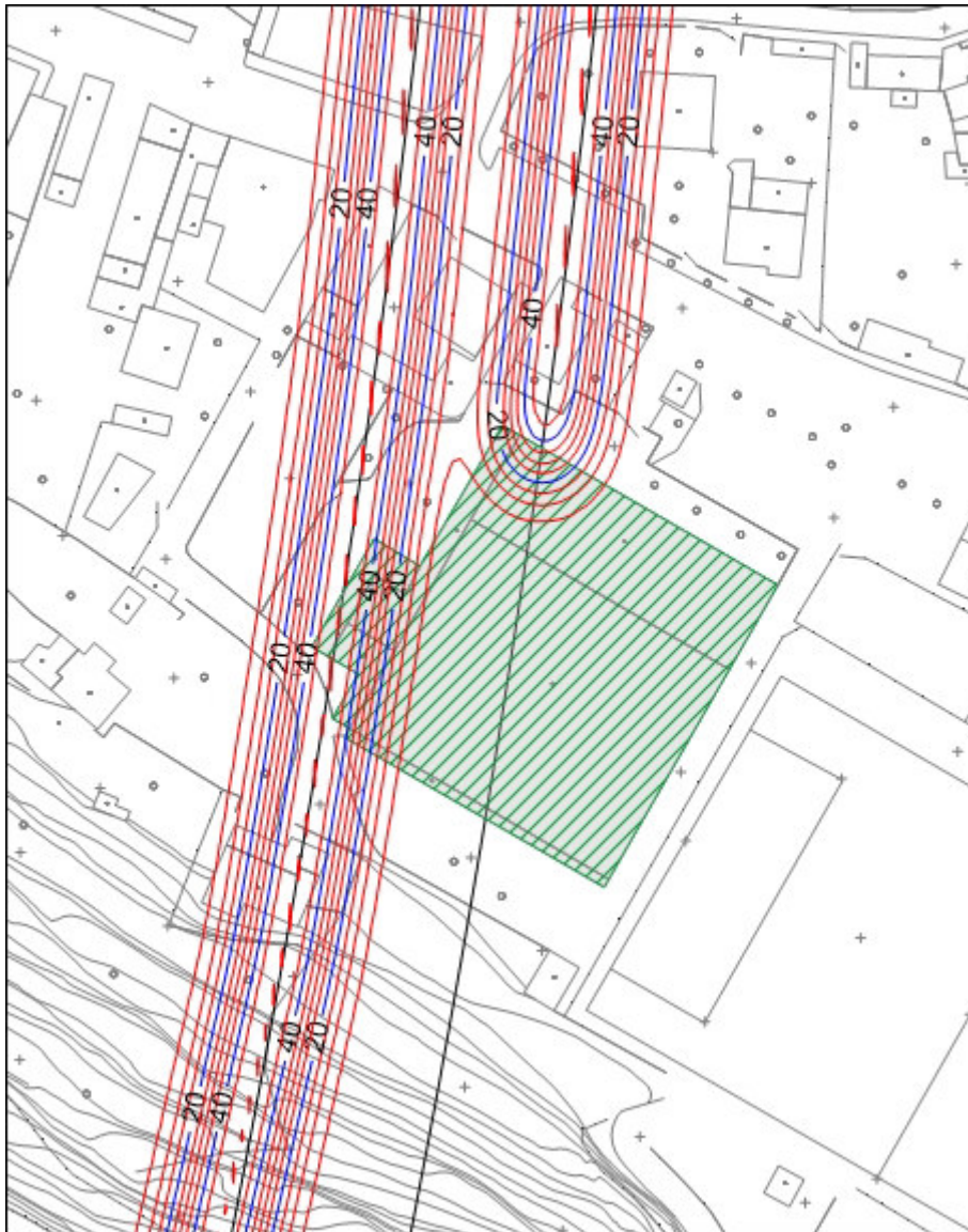
Figura 41: isolinee dei cedimenti w (in mm) – 9° tratto della canna pari – V_L=0,4\%
