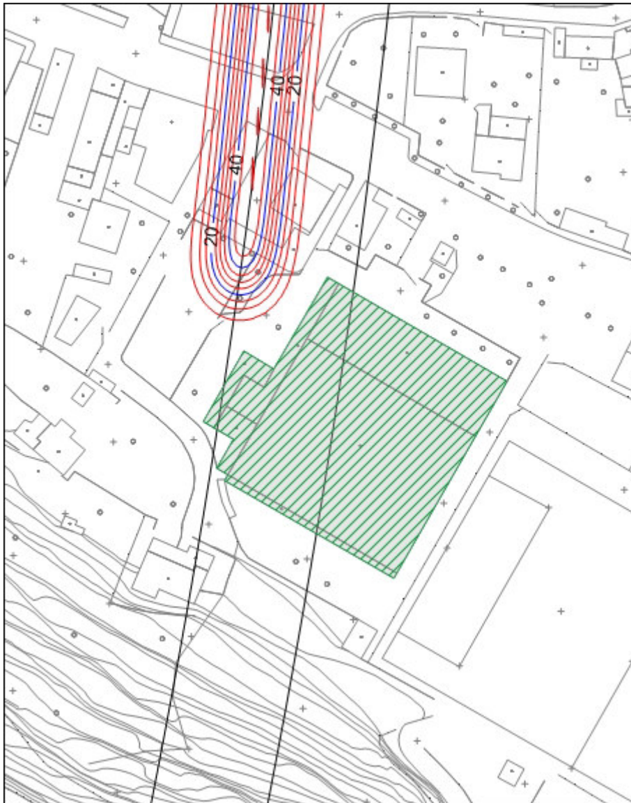
Figura 34: isolinee dei cedimenti w (in mm) – 2° tratto della canna dispari – V_L=0,4\%
