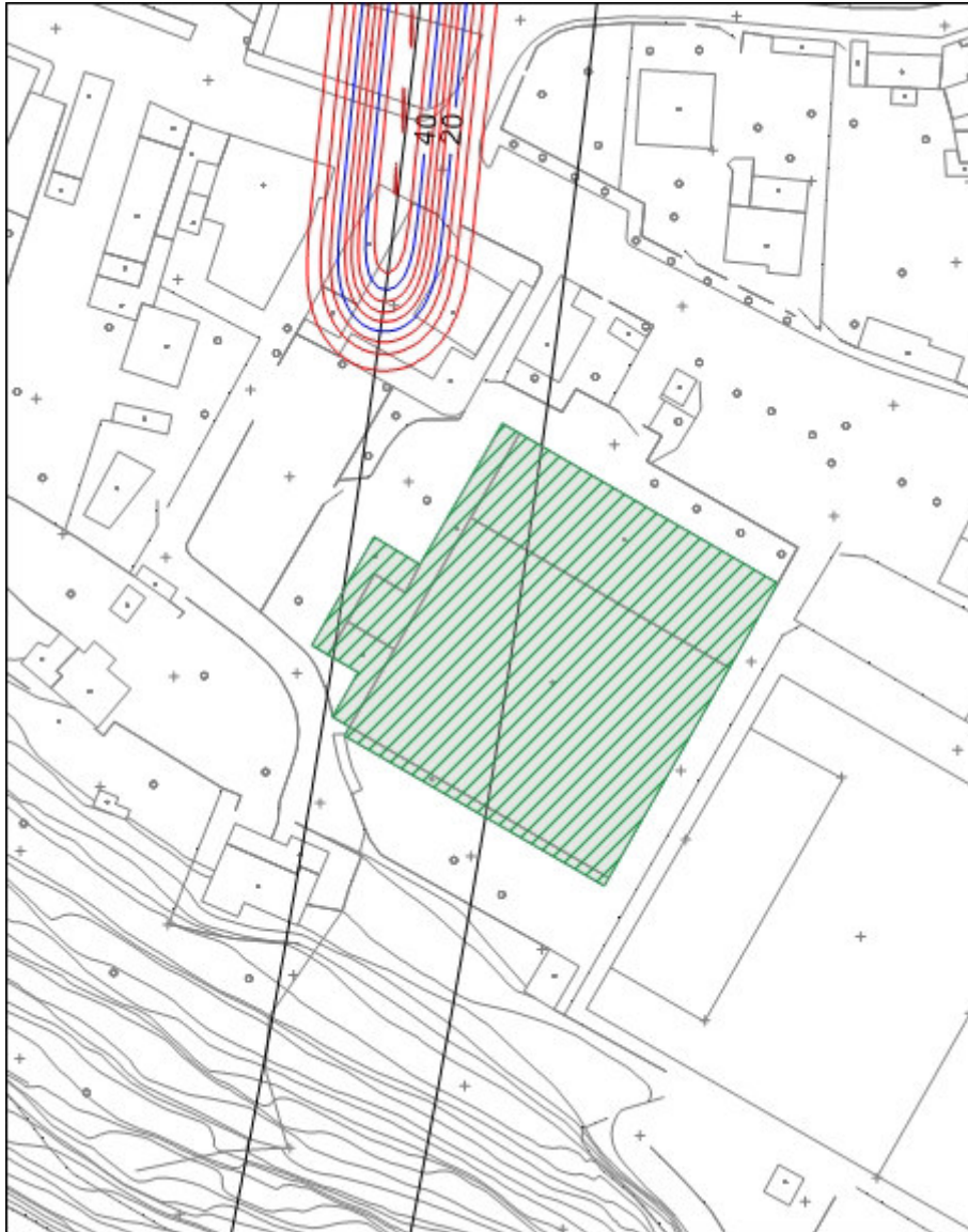
Figura 33: isolinee dei cedimenti w (in mm) – 1° tratto della canna dispari – V_L=0,4\%
