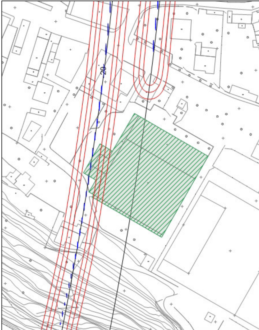
Figura 26: isolinee dei cedimenti w (in mm) – 8° tratto della canna pari – V_L=0,4\%
