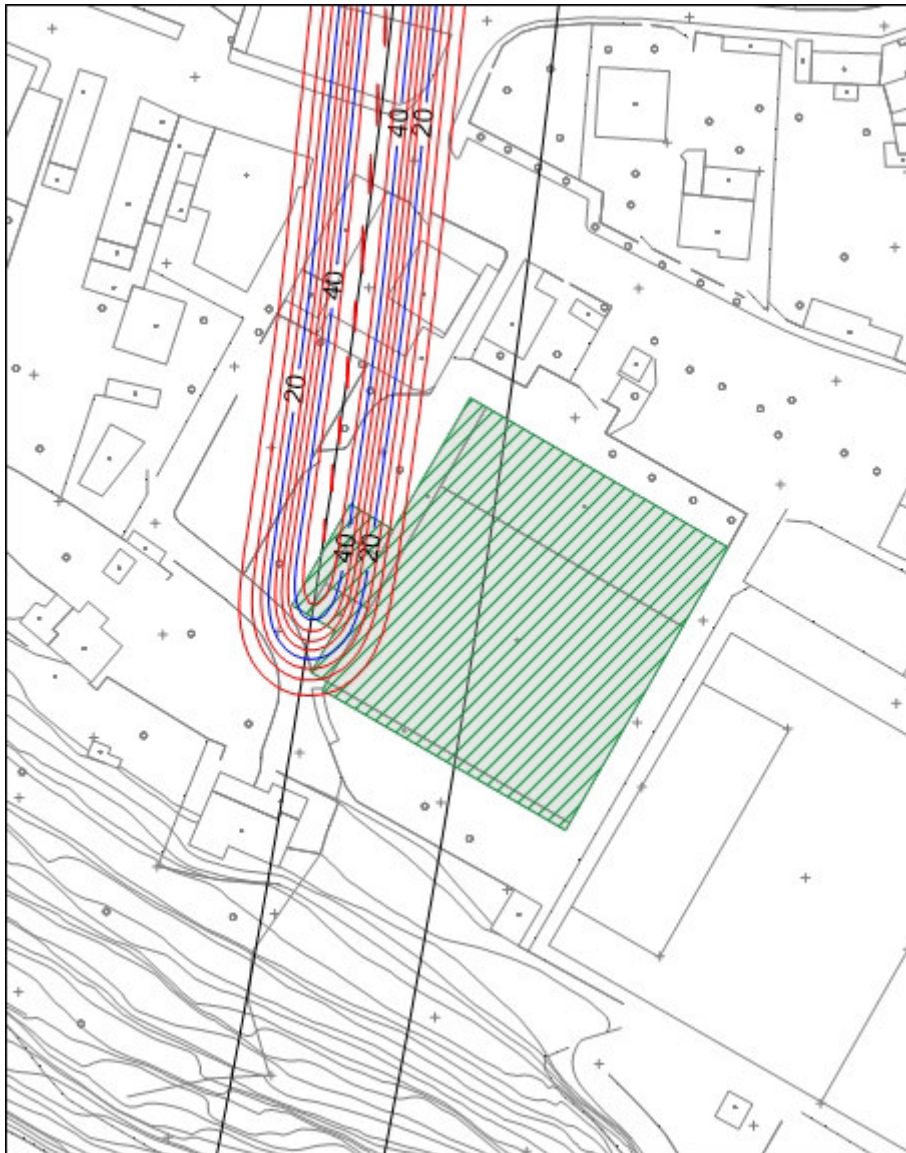
Figura 36: isolinee dei cedimenti w (in mm) – 4° tratto della canna dispari – V_L=0,4\%
