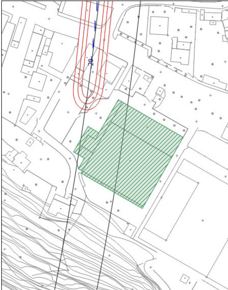
Figura 20: isolinee dei cedimenti w (in mm) – 2° tratto della canna dispari – V_L=0,4\%
