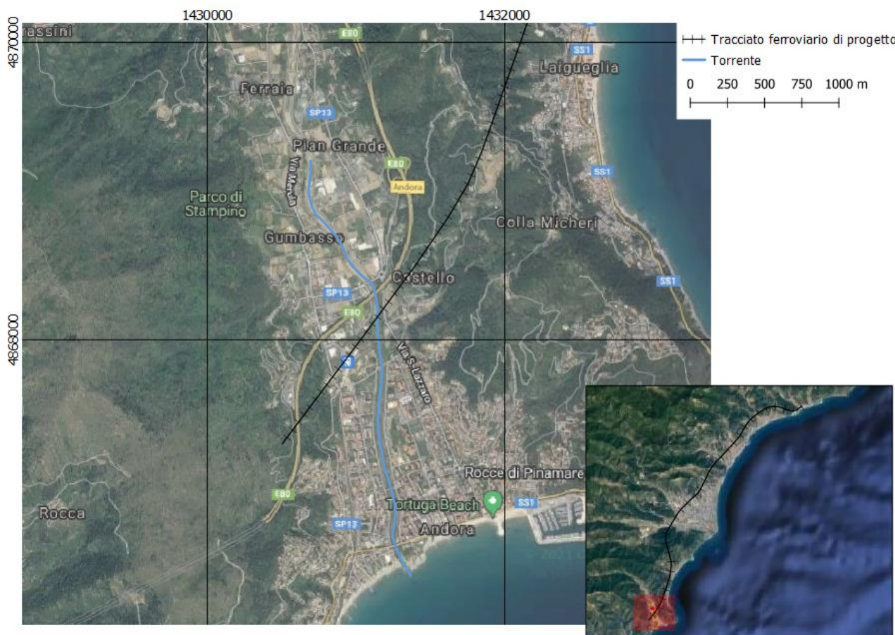
Figura 19: Interferenza idraulica del tracciato ferroviario con l'asse del torrente Merula
