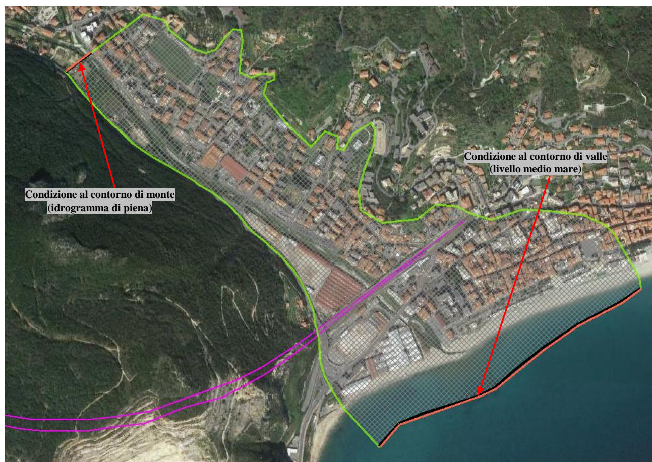
Figura 13 – Condizioni al contorno imposte nel modello.
