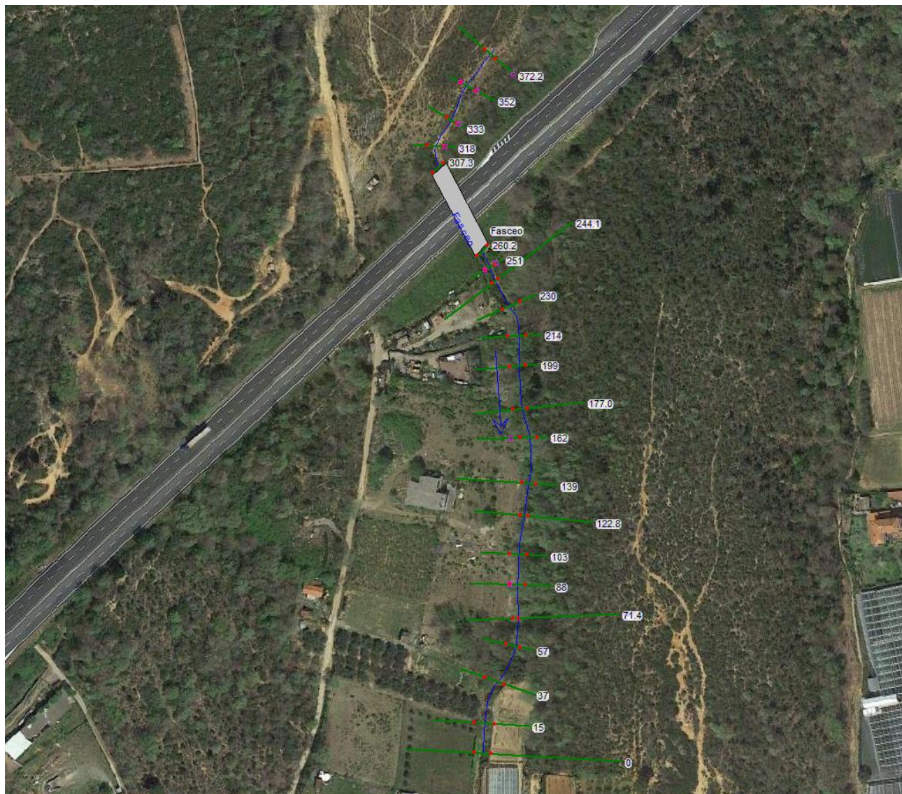
Figura 73: Vista planimetrica della geometria del modello (le etichette indicano le progressive delle sezioni all'interno del modello)
