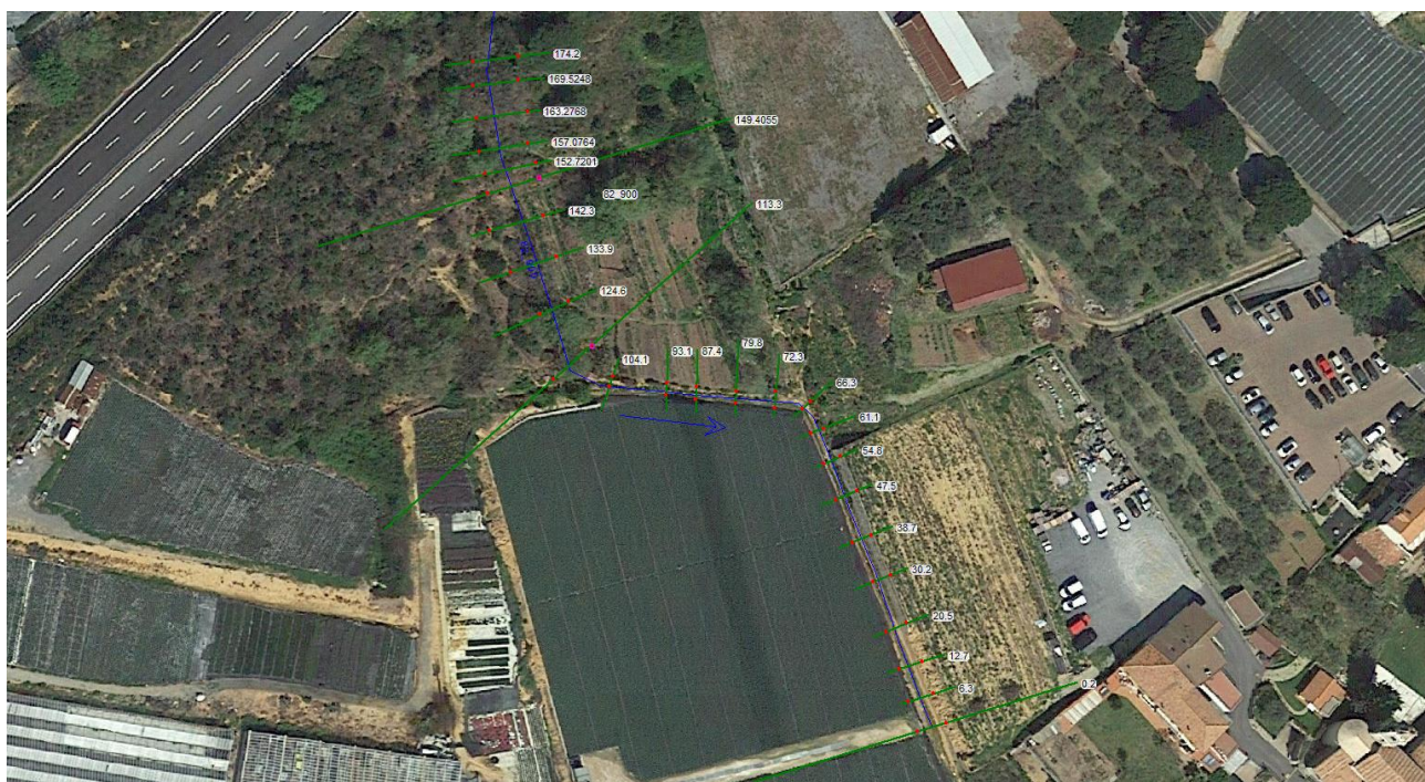
Figura 34: Vista planimetrica della geometria del modello (le etichette indicano le progressive delle sezioni all'interno del modello)
