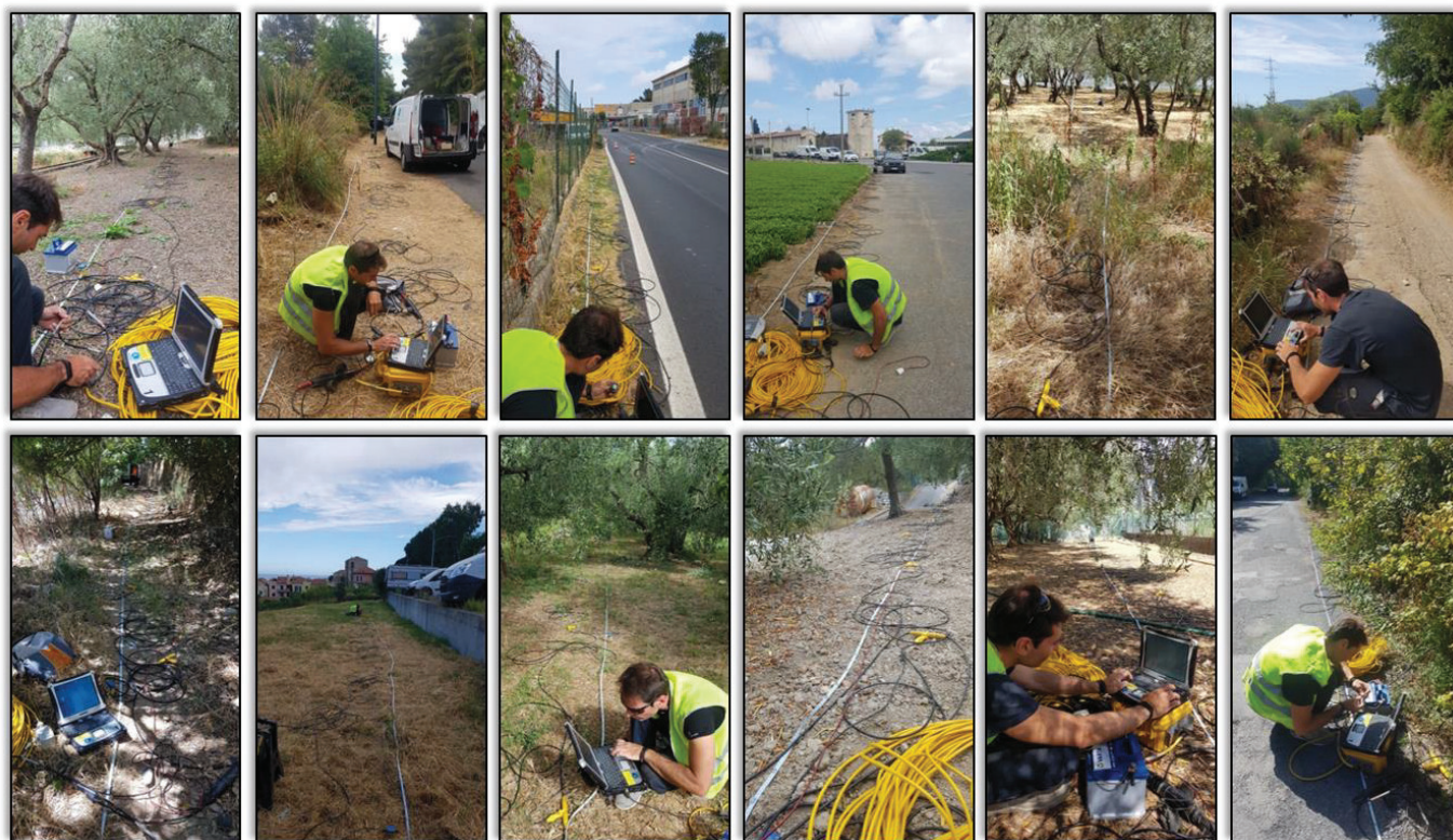
Figura 5 - Fasi di acquisizione di alcune delle MASW effettuate.
