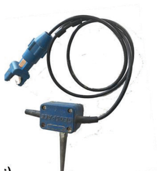
Figura 12 – geofono per onda S con frequenza caratteristica di 8 Hz.
