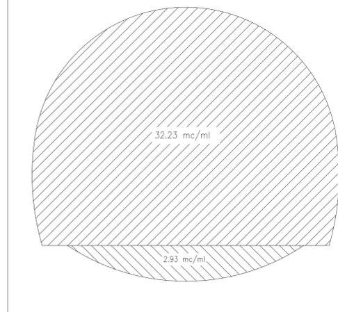
**COLLEGAMENTO TRASVERSALE TECNOLOGICO SEZIONE TIPO C**
