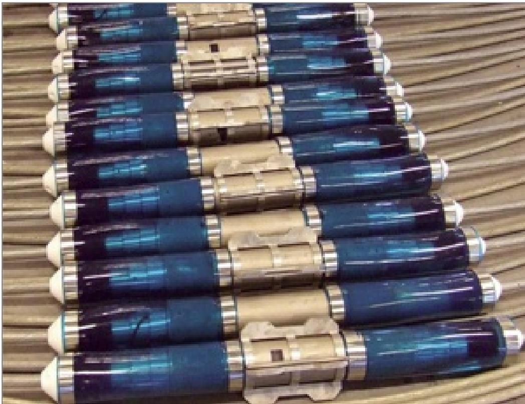
Figura 2.8 – Serie di idrofoni usati per l'acquisizione del segnale off-shore (fonte: [www.oilonline.com](http://www.oilonline.com))
