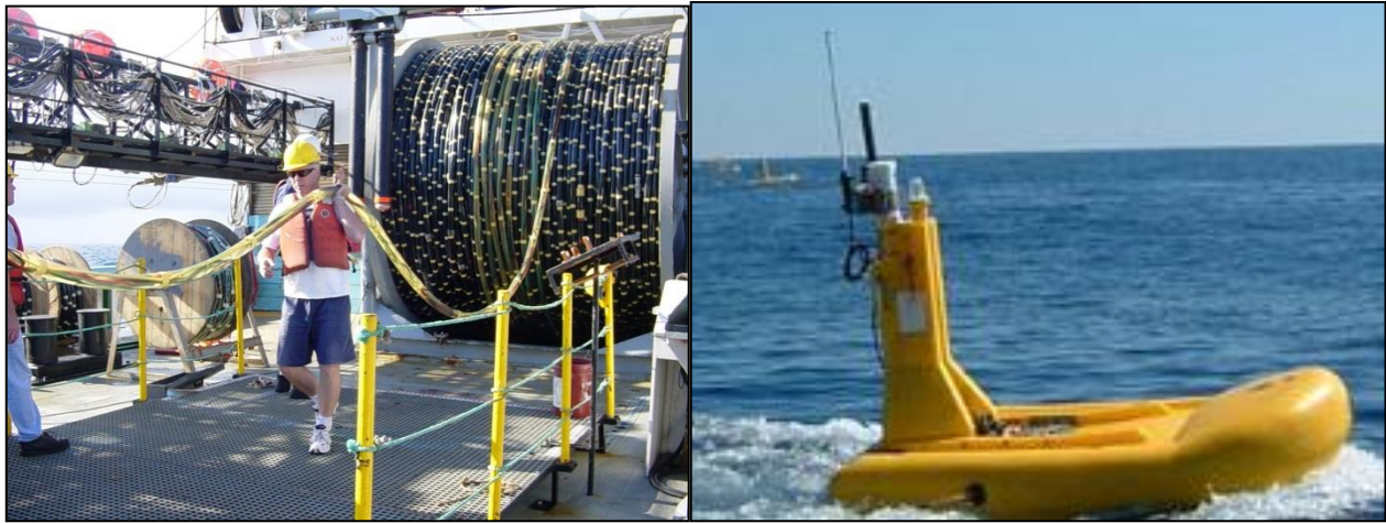
Figura 3.7 – Streamer o cavo sismico per l’acquisizione a sinistra (fonte: www.ig.utexas.edu ) e Boa di coda a destra (fonte: www.seamap.com )
