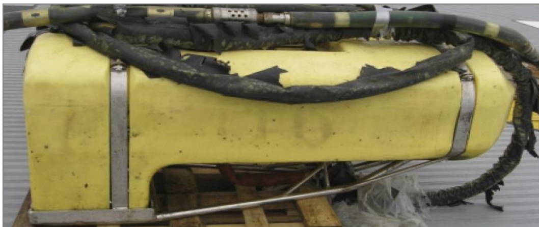
Figura 6.2 – Struttura delle boa di coda del cavo sismico normalmente utilizzata da Western Geco (fonte: Schlumberger)
