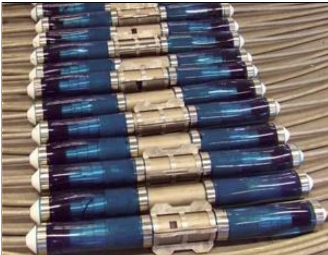
Figura 3.8 – Serie di idrofoni usati per l’acquisizione del segnale off-shore (fonte: www.oilonline.com )
