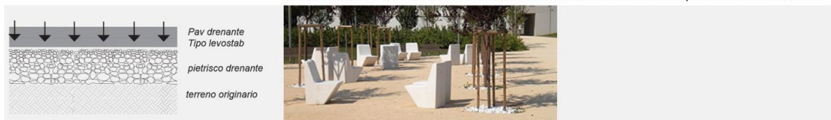
Pavimentazione drenante realizzata con sistema stabilizzante in polvere fibrorinforzata
