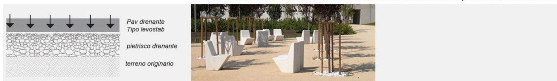
Pavimentazione drenante realizzata con sistema stabilizzante in polvere fibrorinforzato
