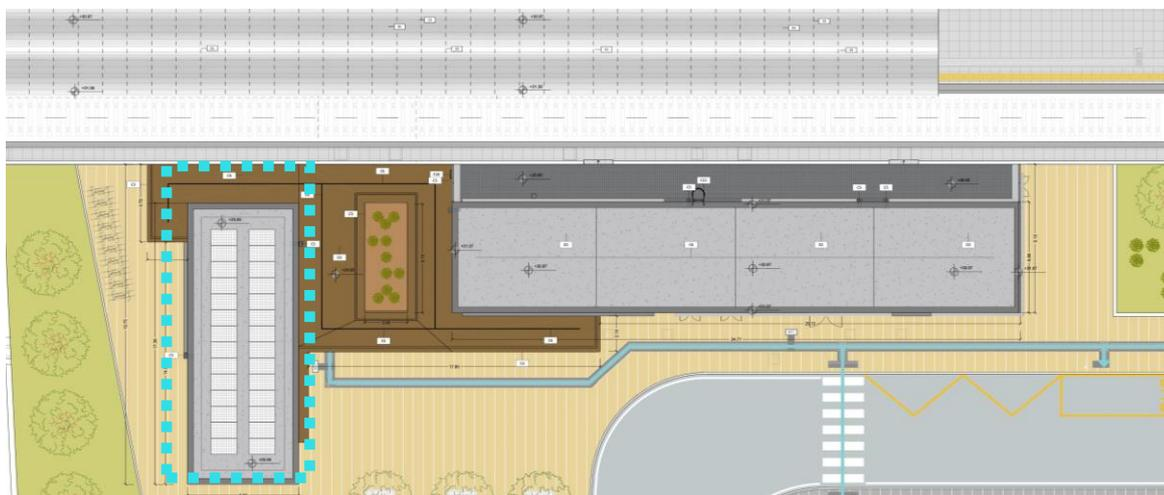
*Planimetria delle coperture con localizzazione del fotovoltaico*
