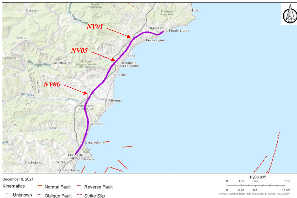
Figura 8.13 Stralcio cartografico dell'area di interesse con indicazione delle faglie capaci (in rosso) (da http://sgi2.isprambiente.it/ithacaweb/Catalogo.aspx ). In viola il tracciato in progetto
