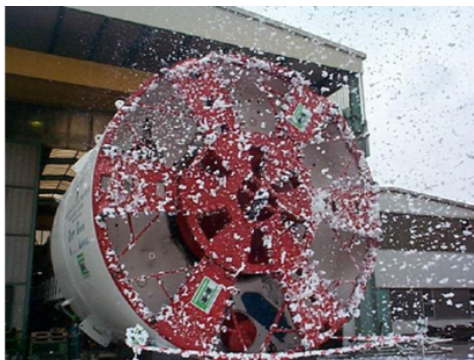
Figura 6 – TBM – EPB, ugelli al fronte per il condizionamento
