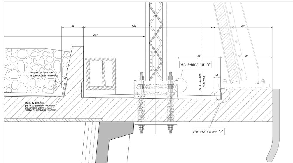
**PARTICOLARE POZZETTO E PARAFOLIE PER PLUVIALE**
