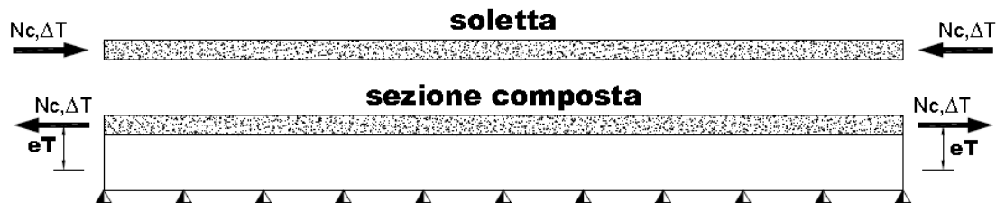
Figura 2-2 - Azioni statiche equivalenti alla variazione termica positiva
