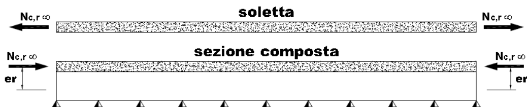
Figura 2-1- Azioni statiche equivalenti al ritiro
