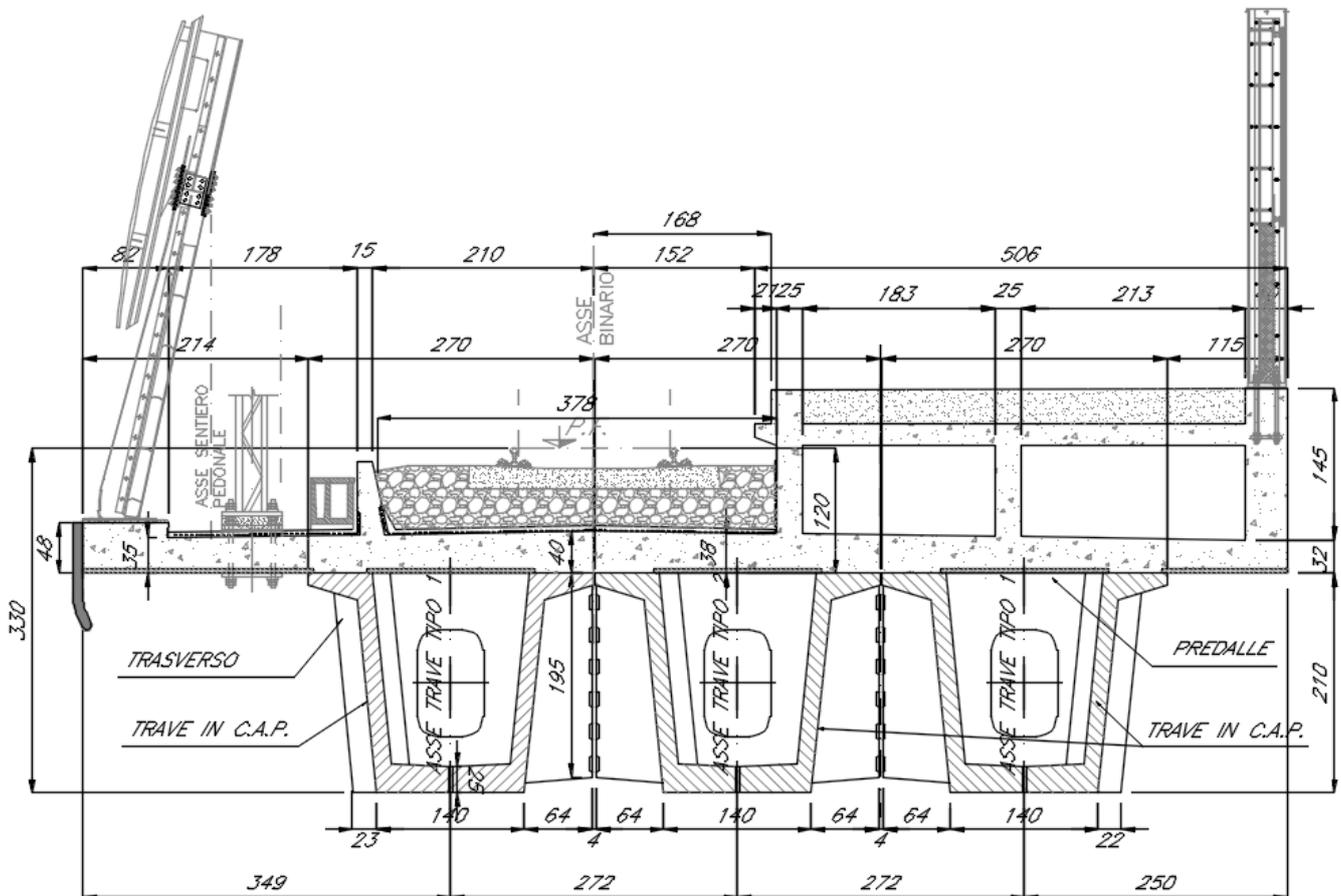
**Figura 4 – Sezione tipica trasversale dell'impalcato**
