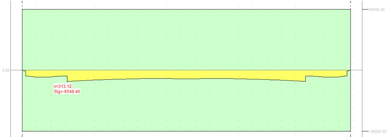
**Figura 11: SLE tensioni acciaio**
