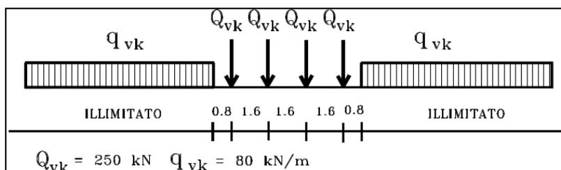
Per tale carico è prevista una eccentricità del carico rispetto all'asse del binbinario pari a 8 cm ( $=s/18$  con scartamento  $s=1435\text{mm}$ ) di cui si è tenuto conto nel modello di calcolo.
