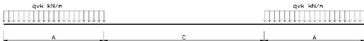
Figura 5 – Treno di carico SW
