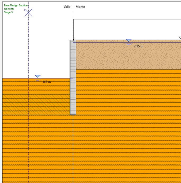
Figura 4: Stage 3 – Scavo a valle fino a raggiungimento quota fondo scavo
