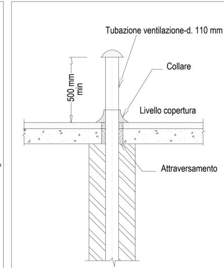
Particolare installazione vaso di scarico - non in scala
