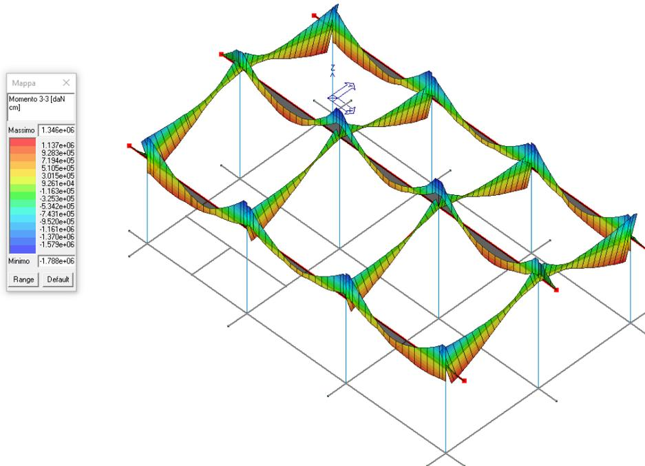
Figura 32 - Copertura - Involuppo M3
