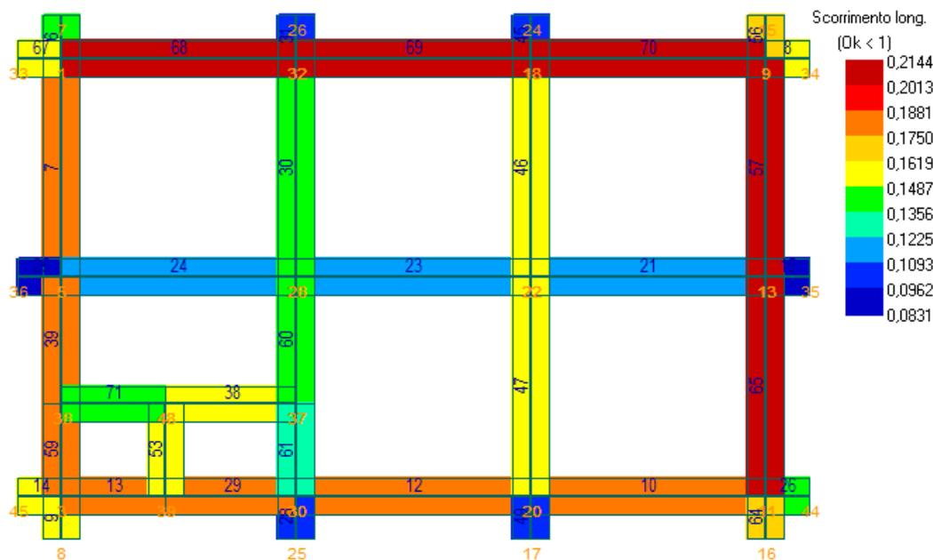
Figura 65 - Verifica Scorrimento longitudinale
