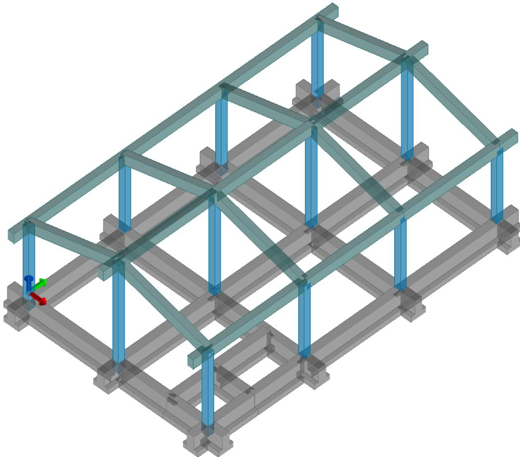
Figura 14 - Modello di calcolo – grafica linee nascoste
