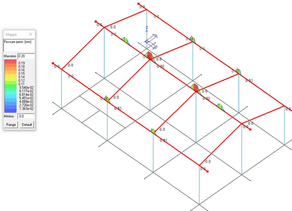
Figura 56 - Verifica stato di fessurazione in combinazione SLE Quasi Permanente
