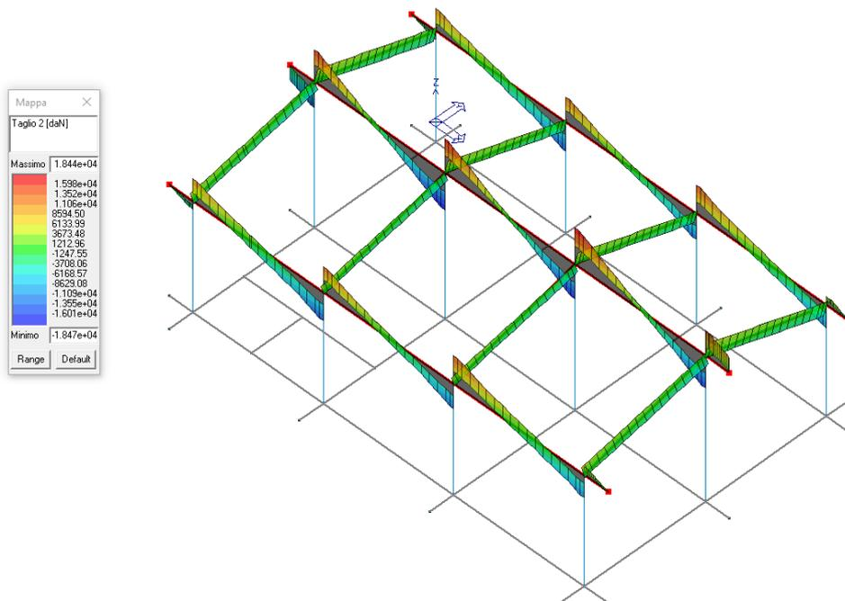
Figura 28 - Copertura - Involuppo V2
