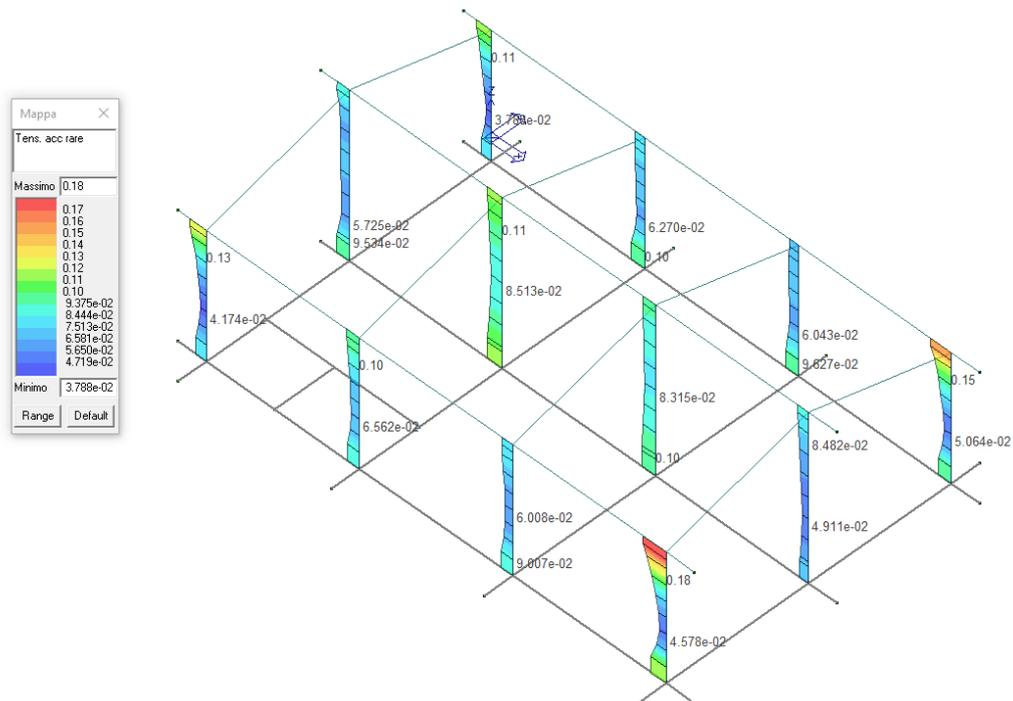
Figura 48 - Verifica tensionale lato acciaio SLE Rara
