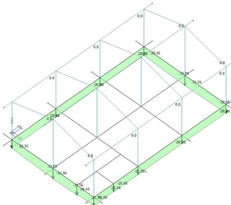
Figura 19 - Pesi propri permanenti non strutturali (CDC4)
