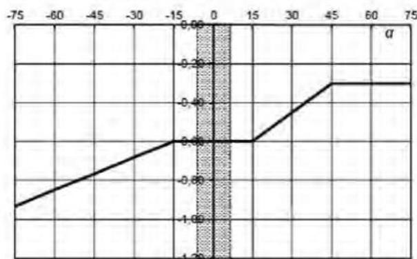
Figura C3.3.12 - Coefficienti di pressione per coperture a doppia falda: falda sottovento con vento in direzione perpendicolare al colmo
