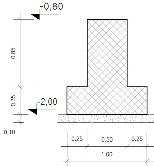
Figura 6 – Sezione tipologica trave rovescia di fondazione
