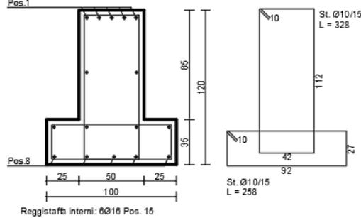
Figura 67 – Tipologico ferri di armatura travi rovesce di fondazione
