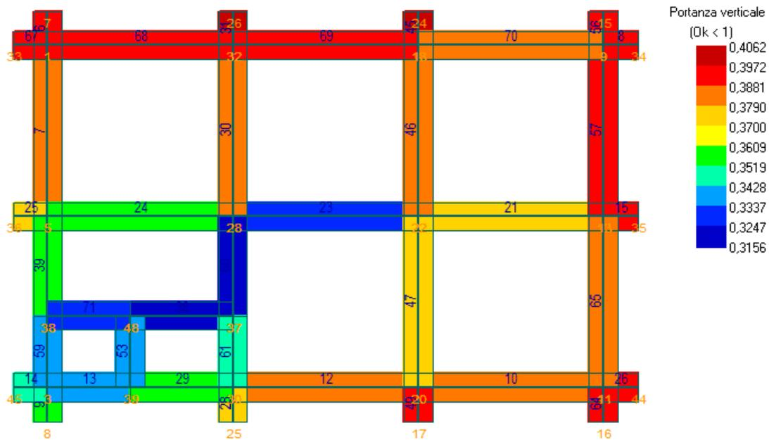
Figura 64 - Verifica Carico limite terreno
