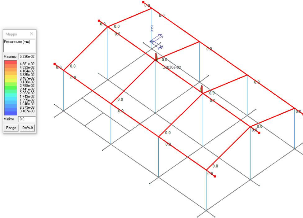
Figura 55 - Verifica stato di fessurazione in combinazione SLE Rara
