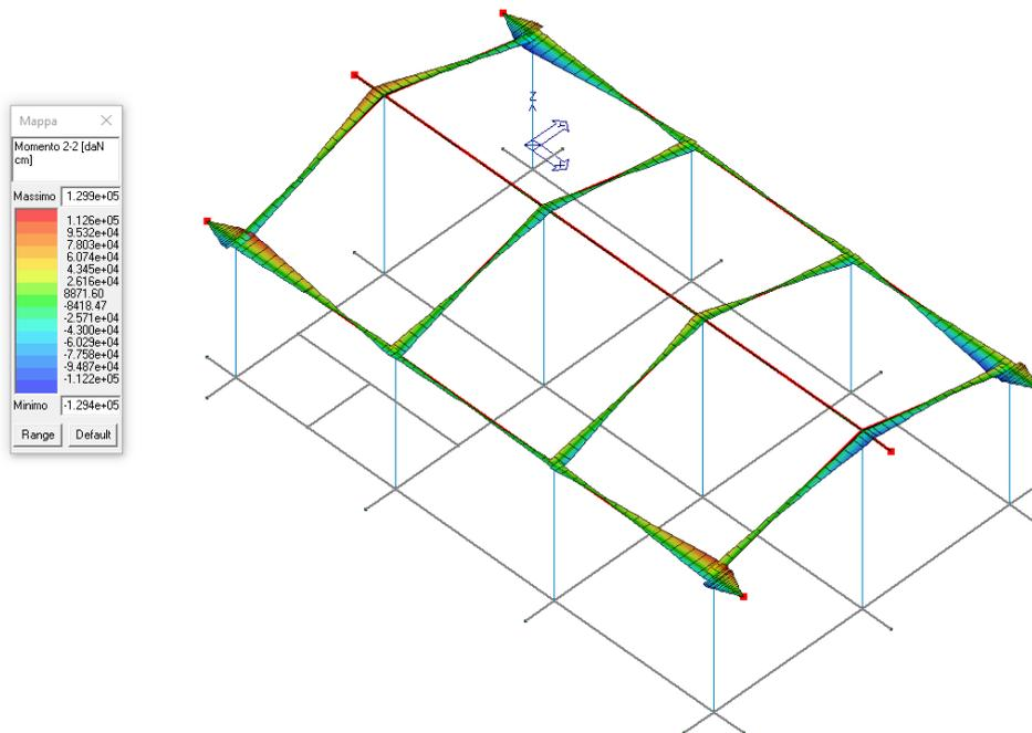
Figura 30 - Copertura - Inviluppo M2
