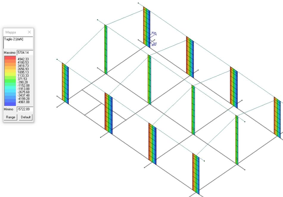
Figura 34 - Pilastr - Involuppo V2
