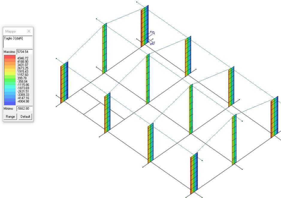
Figura 35 - Pilastri - Inviluppo V3
