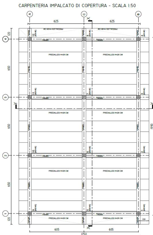
Figura 2 - Struttura intelaiata del fabbricato in pianta
