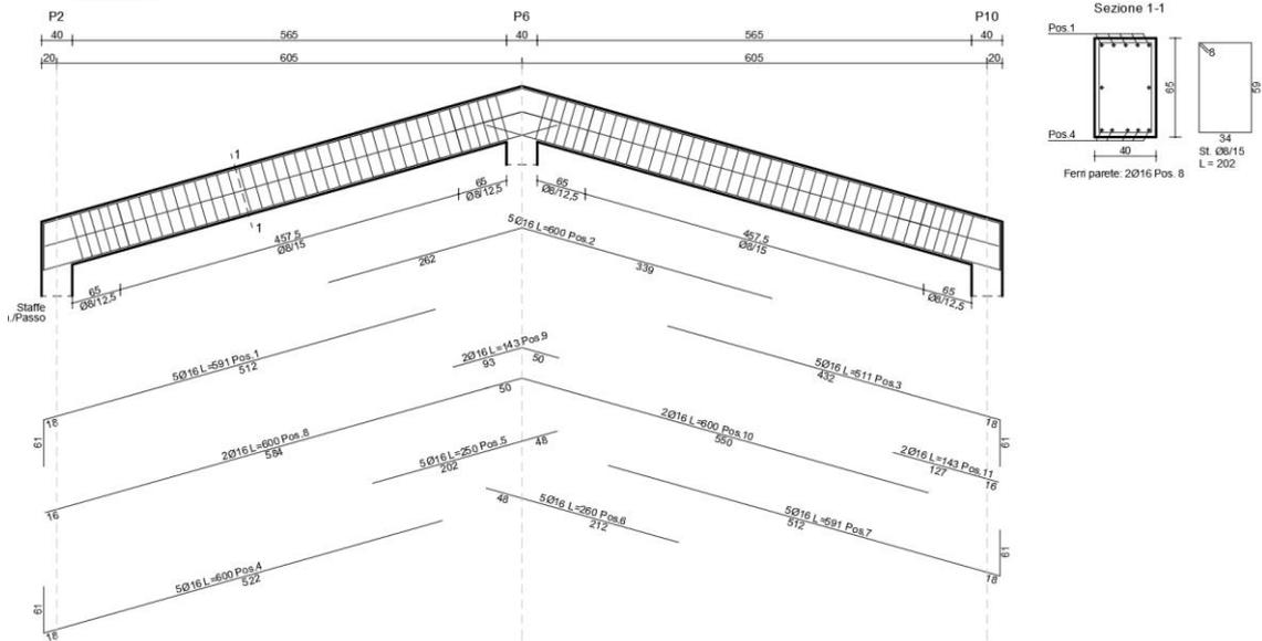
Figura 57 – Tipologico ferri di armatura travi di bordo, di colmo e secondarie
