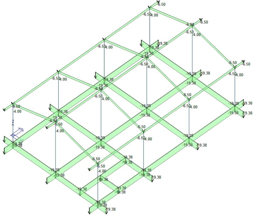
Figura 16 - Pesì propri permanenti strutturali (CDC1)
