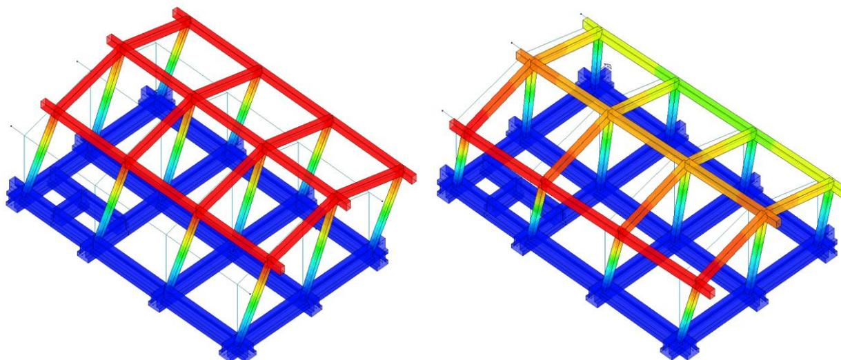
Figura 26 - Modo 1 –  $T_1 = 0.59$  s / Modo 2 –  $T_2 = 0.58$  s
