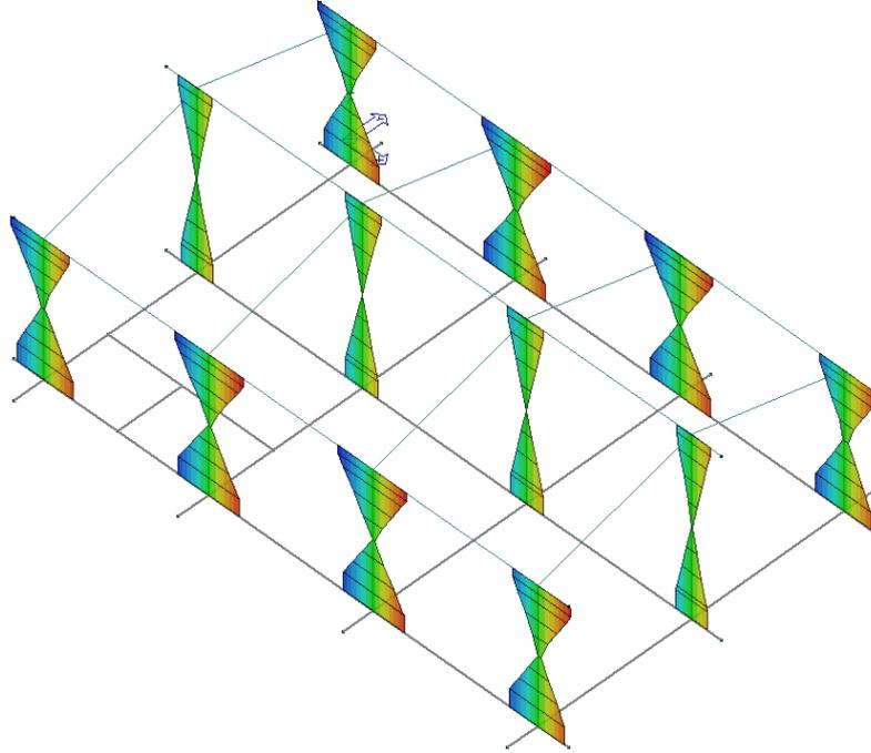
Figura 37 - Pilastri - Involuppo M3
