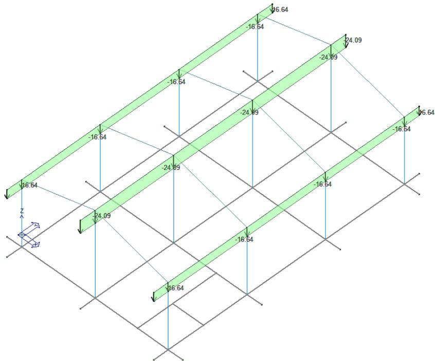
Figura 17 - Pesì propri permanenti strutturali (CDC2)
