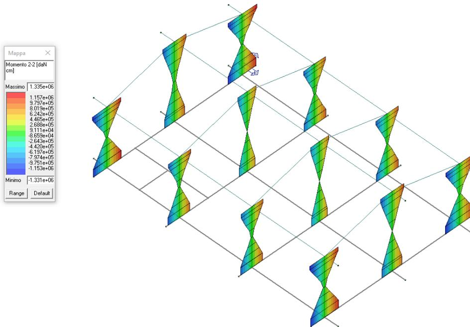
Figura 36 - Pilastri - Inviluppo M2
