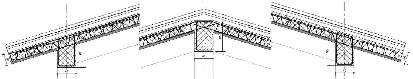
Figura 4 - Doppia falda di copertura in prédalles
