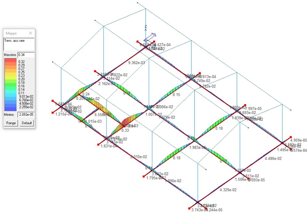
Figura 62 - Verifica Tensioni Acciaio SLE Rara
