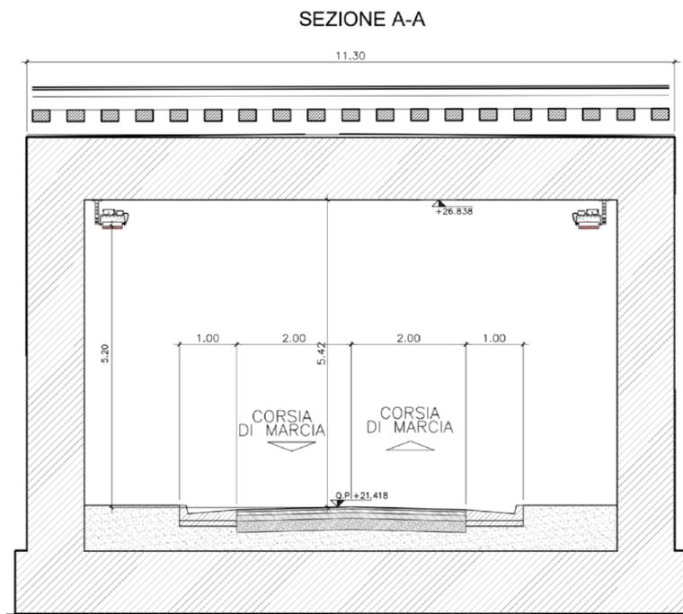
**Figura 3 - Montaggio proiettori in sezione**
