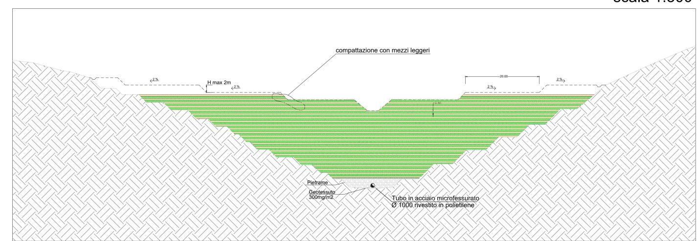
Protezione delle scarpate Canali di gronda per raccolta acque meteoriche con terreno di scotico e biostuoia
