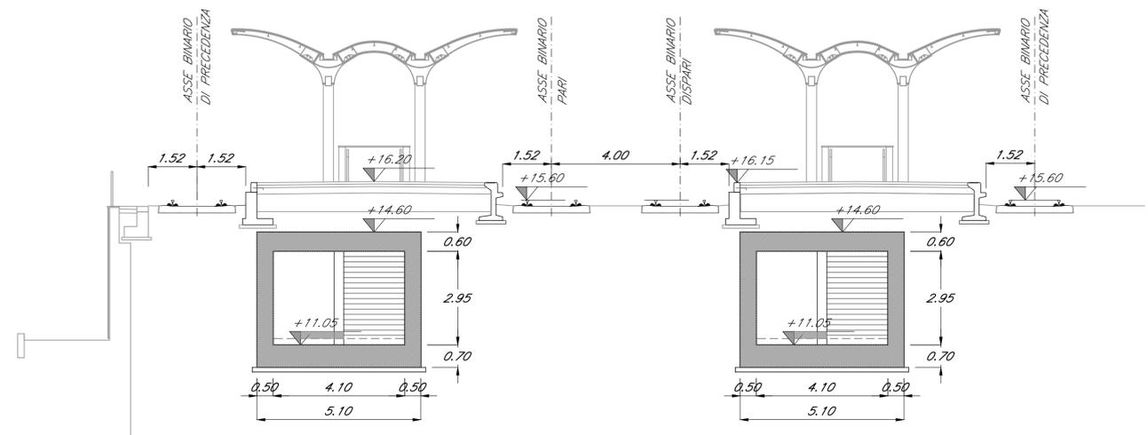
DD SEZIONE D-D - SEZIONE RAMPA
