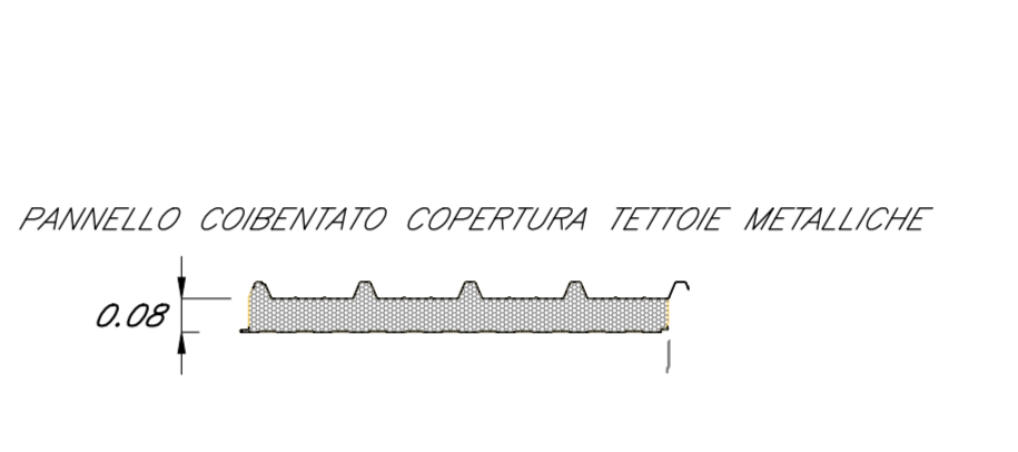
PANNELLO COIBENTATO COPERTURE METALLICHE scala 1:20
