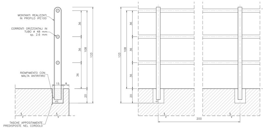
RINCHIERA IN ACCIAIO CLASSE S275J0 O SUPERIORE SECONDO NORMA UNI EN 10025-2005, ZINCATO A CALDO SECONDO NORMATIVA UNI EN 1461
