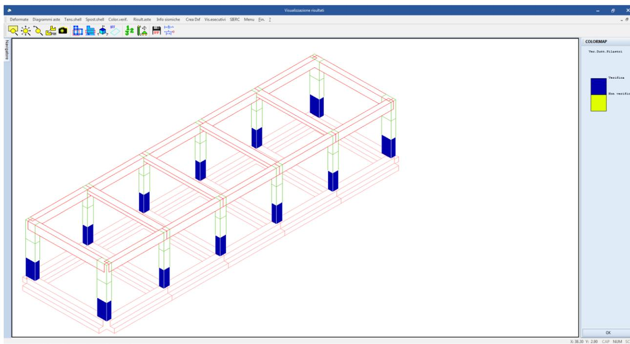
**Figura 24: colormap verifica duttilità spiccato pilastri**
