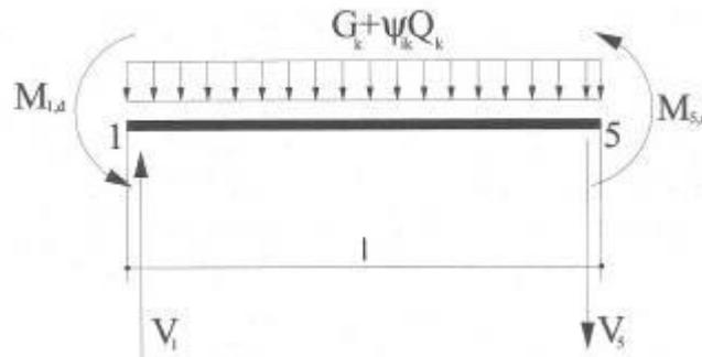
**Figura 30: calcolo delle forze di taglio sulle travi secondo il criterio della capacità**
