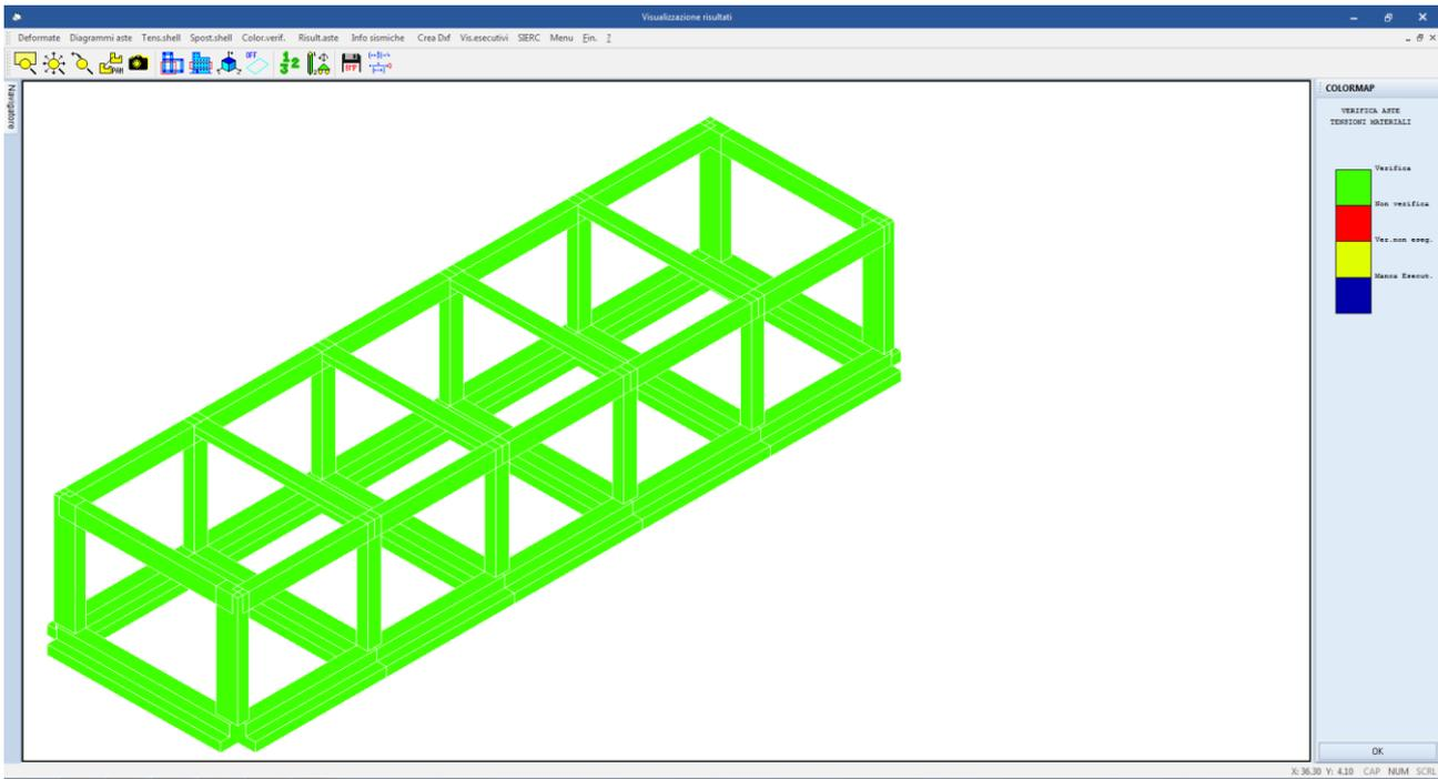
**Figura 26: colormap verifica stato limite di tensione c.a.**
