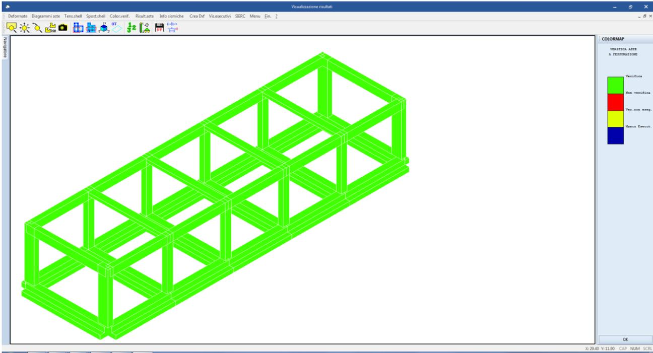
**Figura 25: colormap verifica stato limite di fessurazione**
