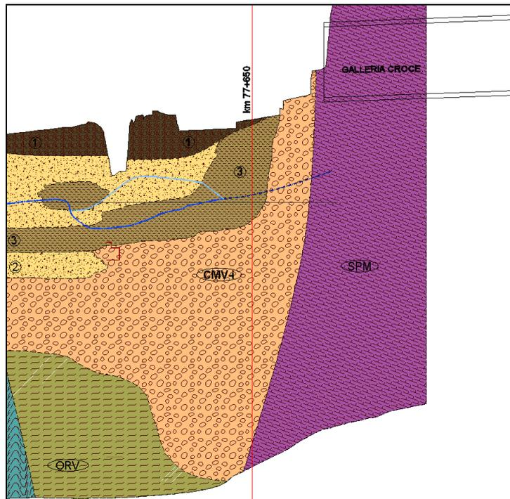
**Figura 3: Profilo geotecnico in prossimità della progressiva Km 77+650**
