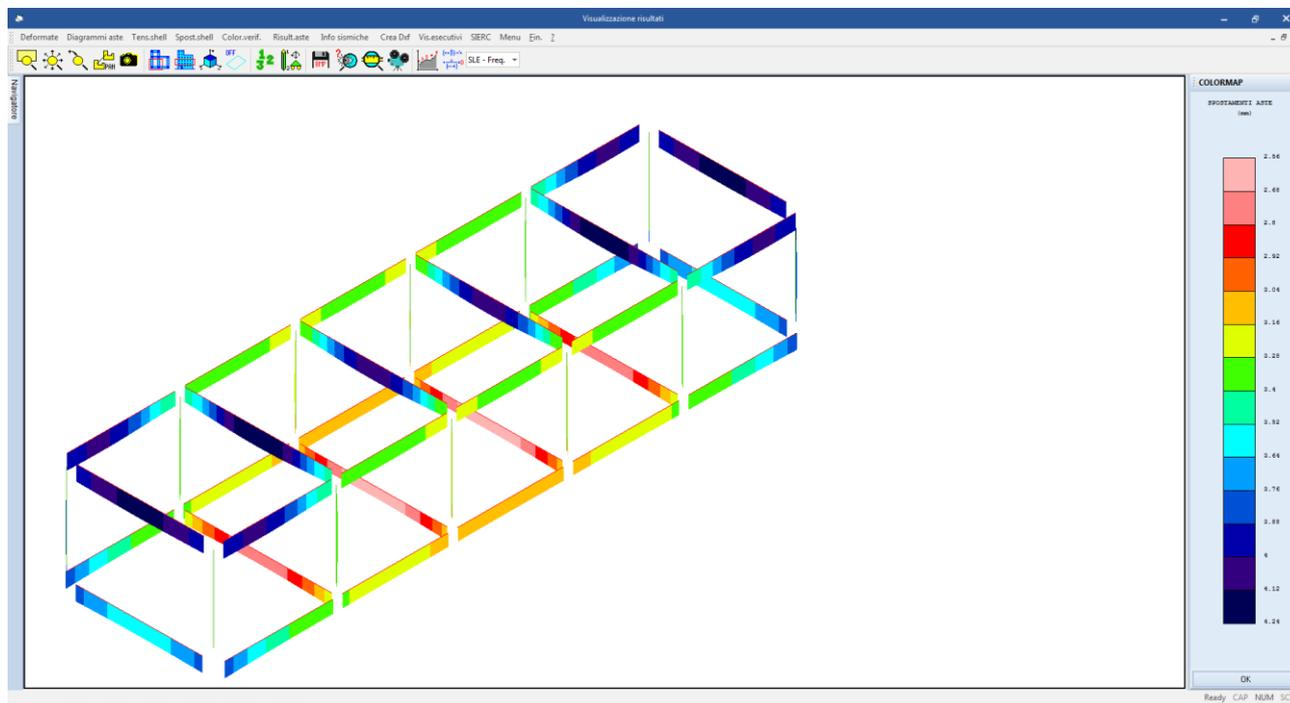
**Figura 23: colormap deformata combinazione SLE frequente n.1**
