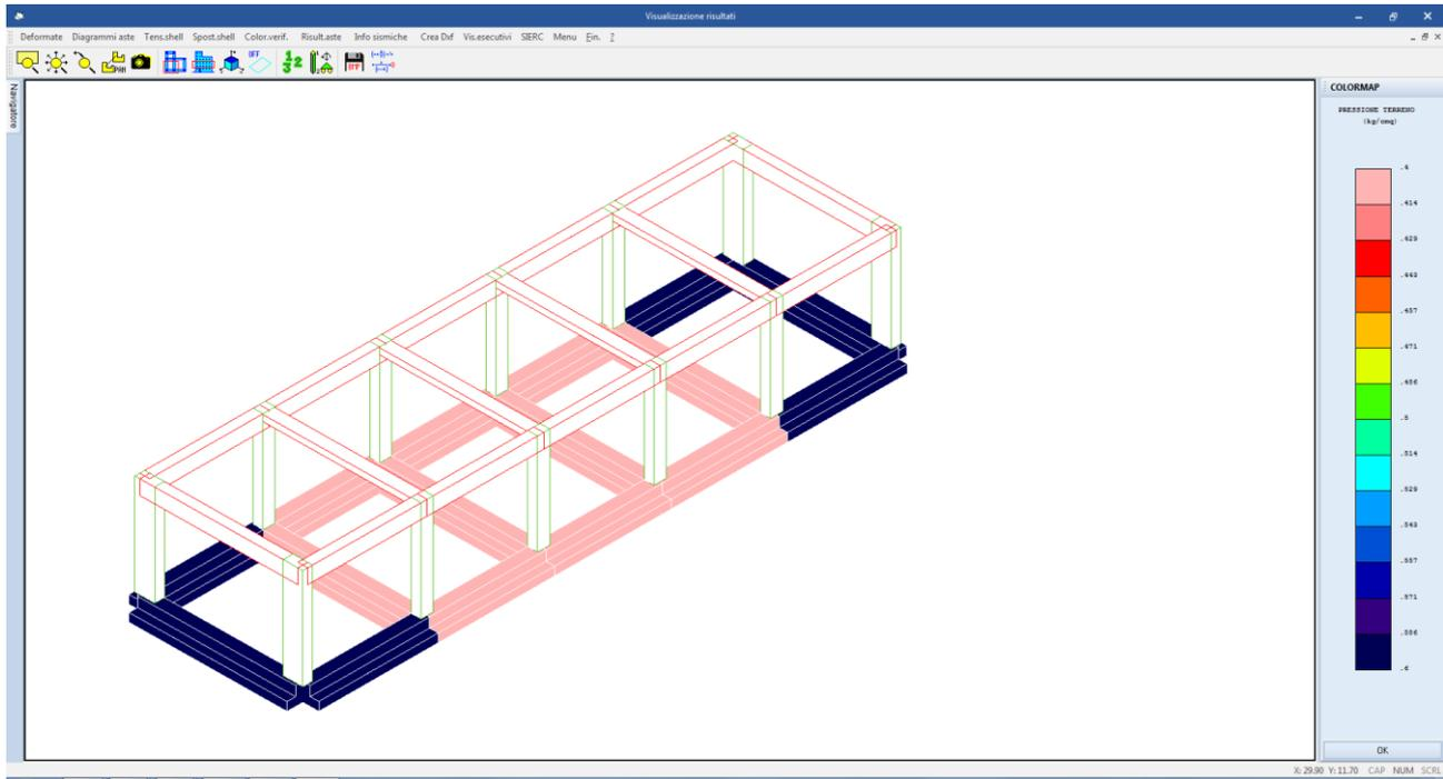
**Figura 34: pressioni di contatto col terreno in combinazione SLV1 (max = 0.60 daN/cm<sup>2</sup>)**
