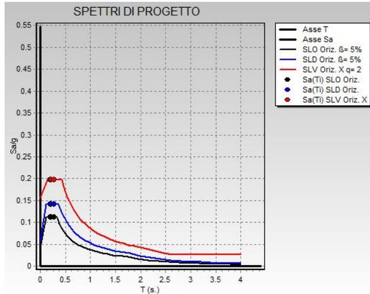
**Figura 11: frequenze proprie della struttura sugli spettri di progetto SLV, SLD, SLO**
