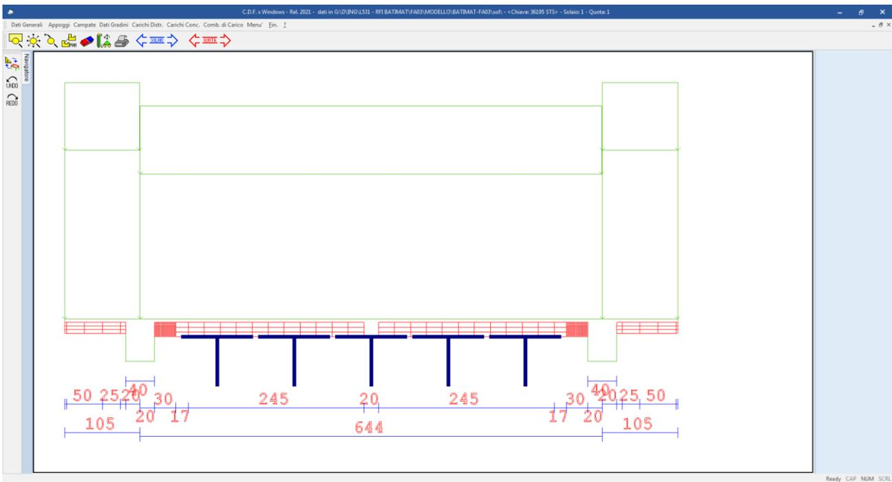
**Figura 32: schema di calcolo del solaio**
