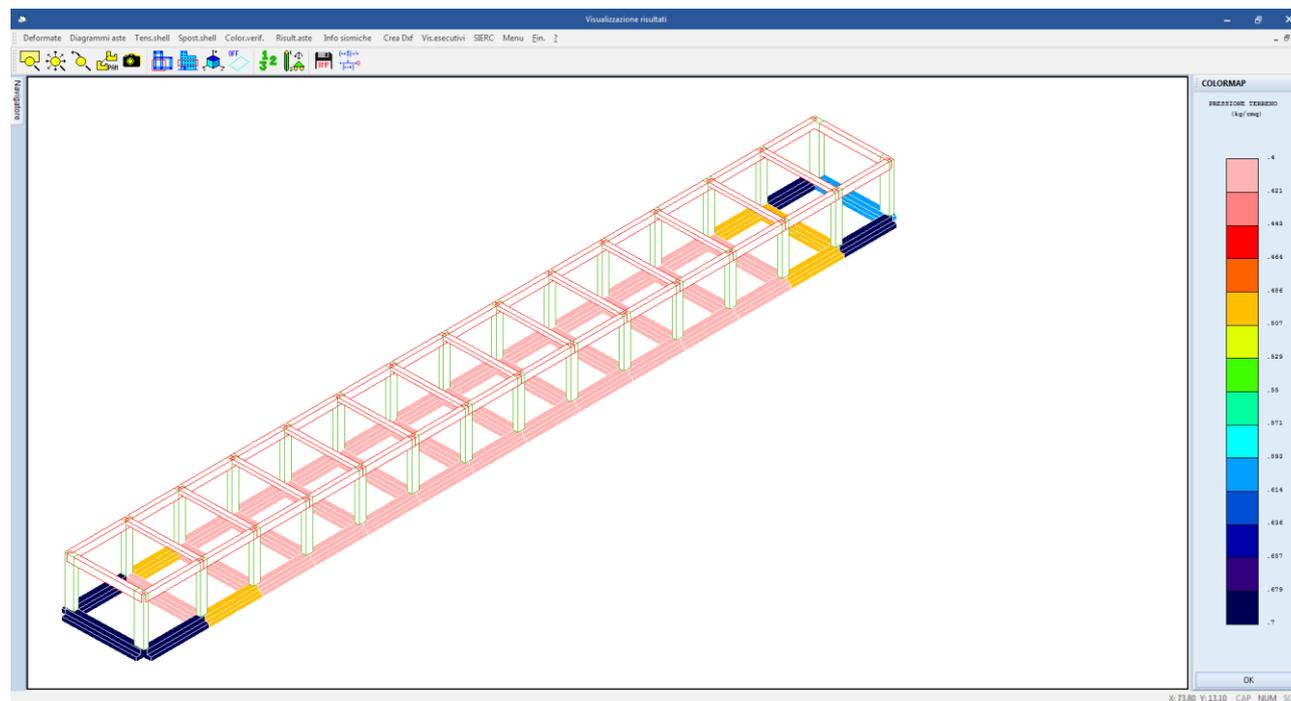
Figura 33: pressioni di contatto col terreno in combinazione SLV1 (max = 0.70 daN/cm<sup>2</sup>)
