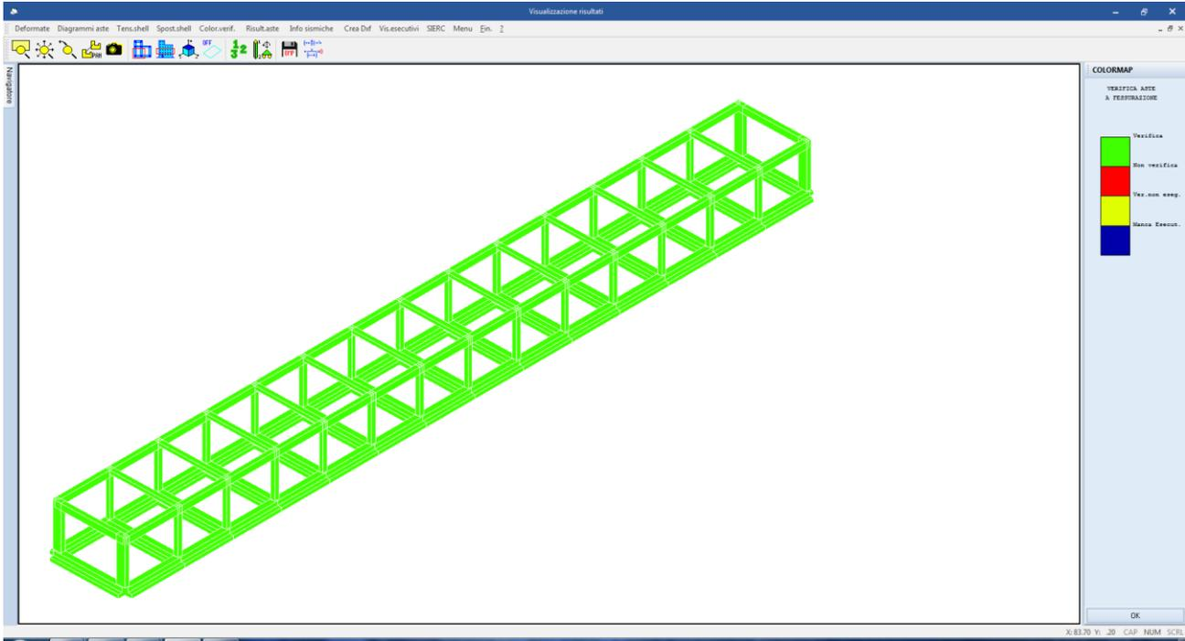
**Figura 24: colormap verifica stato limite di fessurazione**
