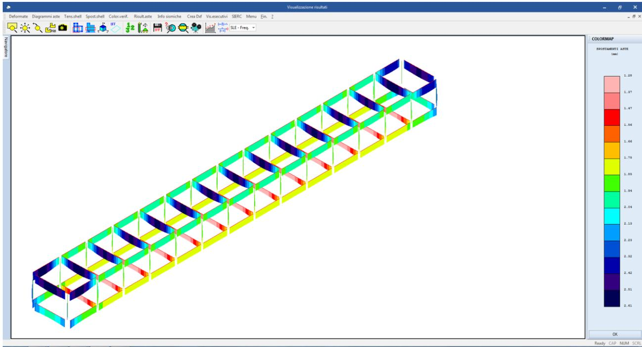
**Figura 22: colormap deformata combinazione SLE frequente n.1**
