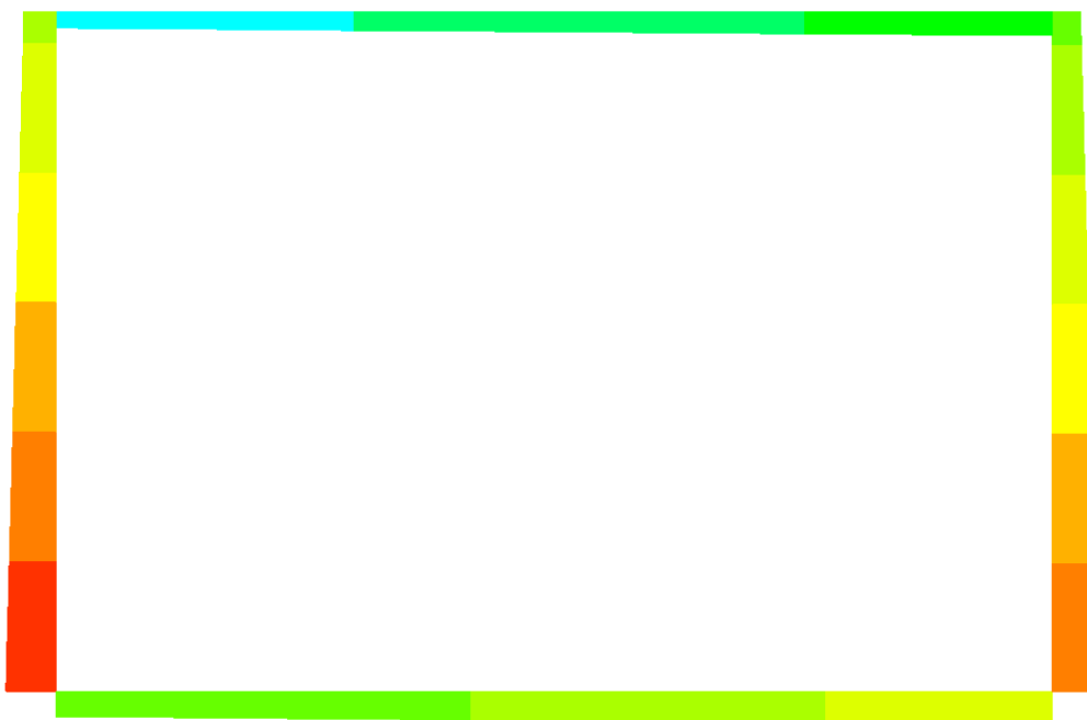
Figura 10-5 Involuppo SLU SLV Azione assiale
