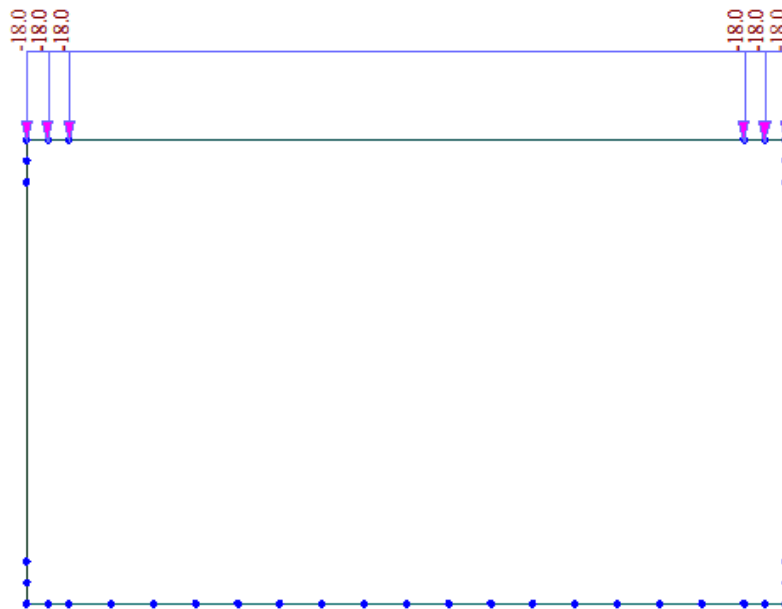
Figura 10: Carichi sulla soletta superiore
