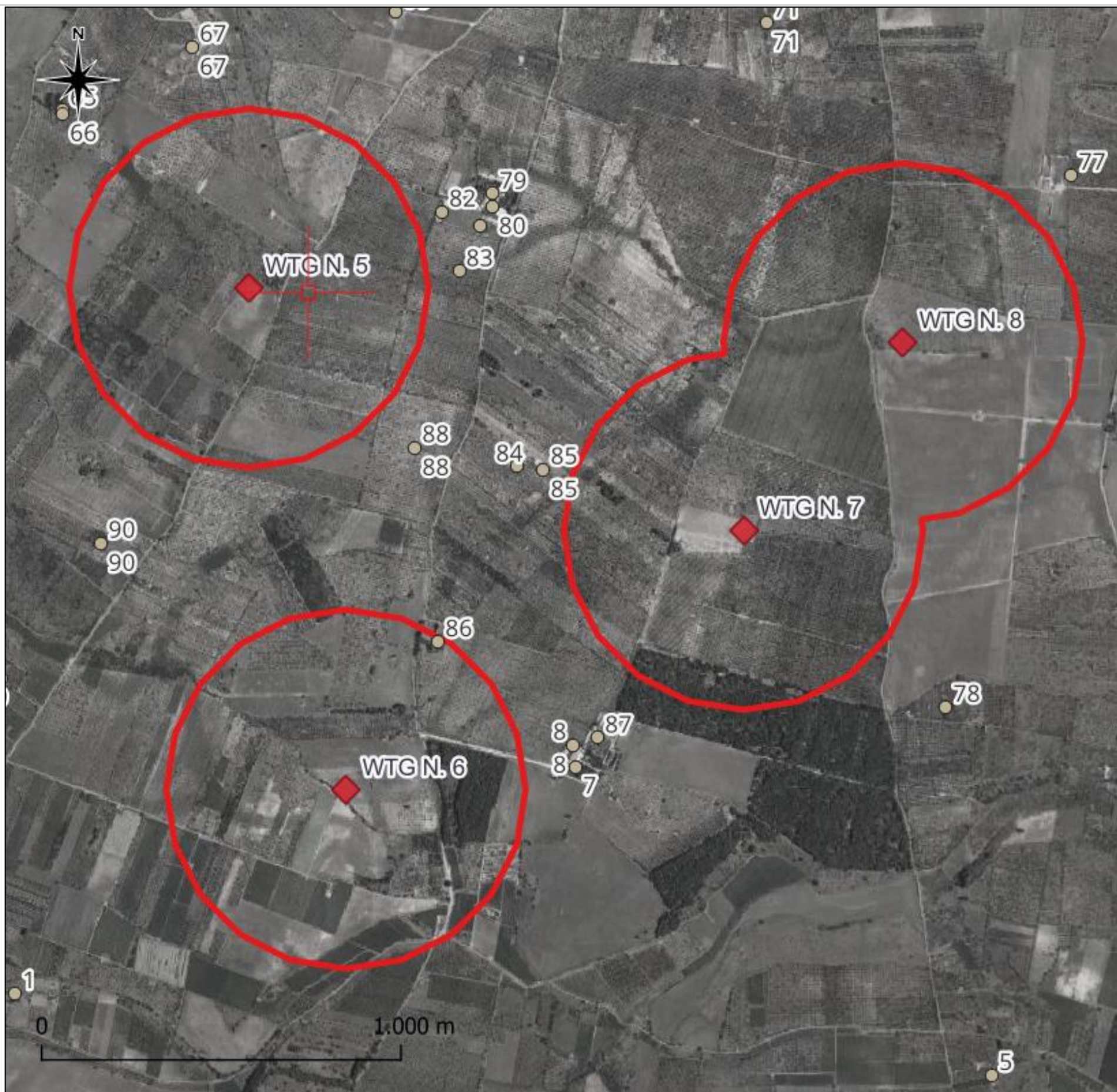
Inquadramento su ortofoto delle WTG 5-8, Buffer di 500 metri in rosso e ricettori in grigio
