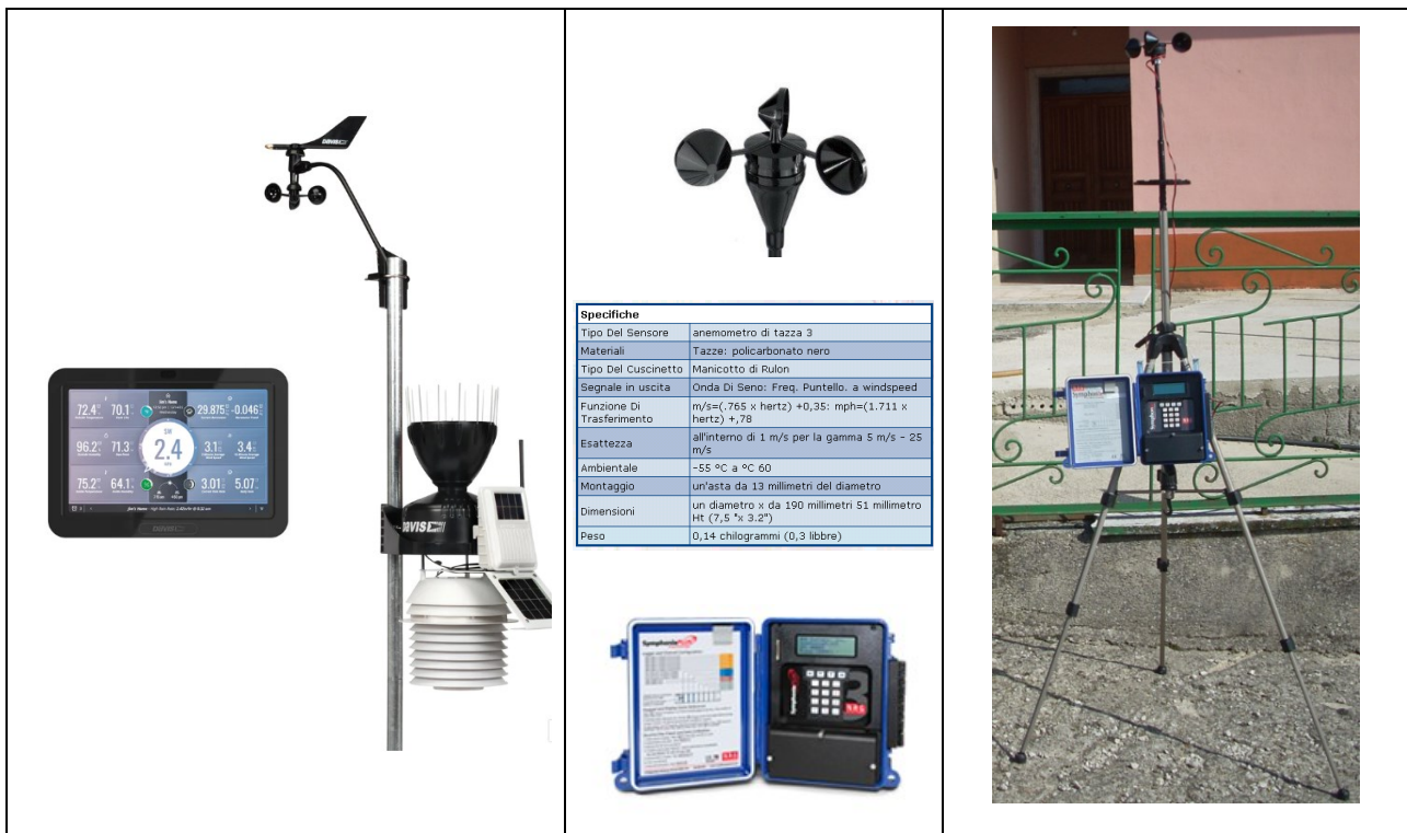
Figura 2: Stazione meteo Davis VantagePro2 -stazione meteo portatile utilizzata- l'altezza di misura dei sensori è 1,5 m; Specifiche tecniche dell'NRG #40 Maximum caratteristiche tecniche DATA LOGGER – Stazione meteo Davis VantagePro
