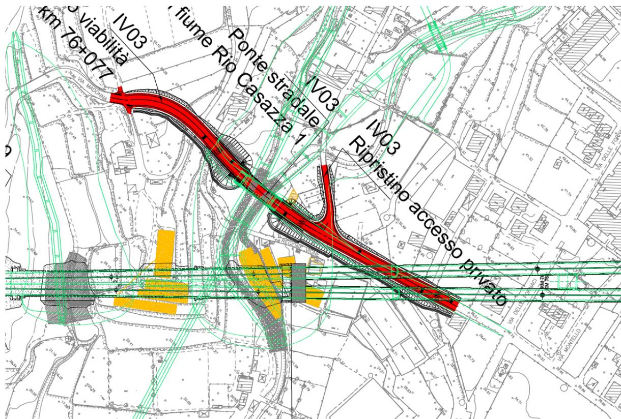
**Figura 14 - IV03 - Confronto P.P. 2003 (in verde) e il P.D. in esame (in rosso). In giallo elementi già assenti non oggetto di SIA (doc. IV0100D22RGSA0001001)**
