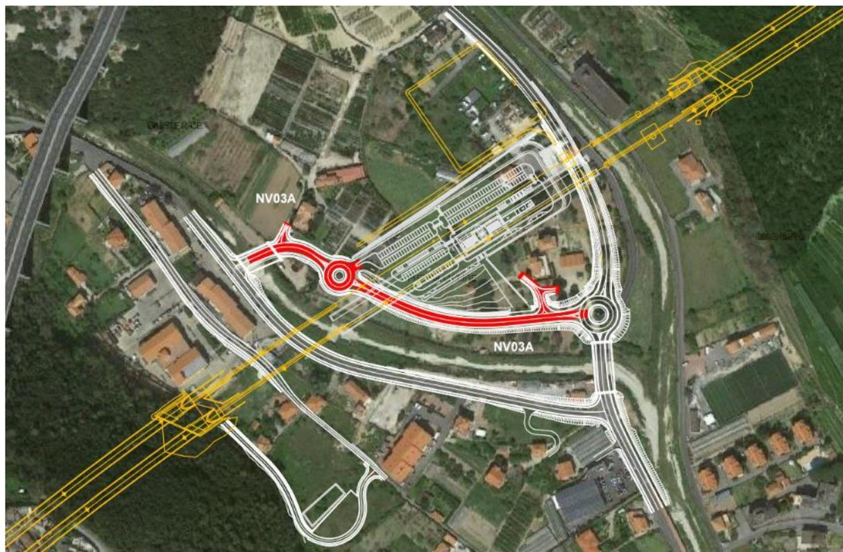
**Figura 7 - Nuova viabilità NV03 (in rosso nell'immagine soprastante) - Collegamento zona parcheggio aree agricole. In giallo elementi già assentiti non oggetto di SIA (doc. IV0I00D22RGSA0001001)**
