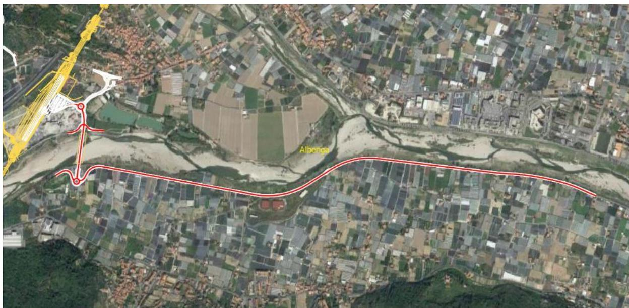
**Figura 41 – L'intervento di adeguamento della strada arginale lungo l'Arroschia. In giallo elementi già assenti non oggetto di SIA (doc. IV0I00D22RGSA0001001)**
