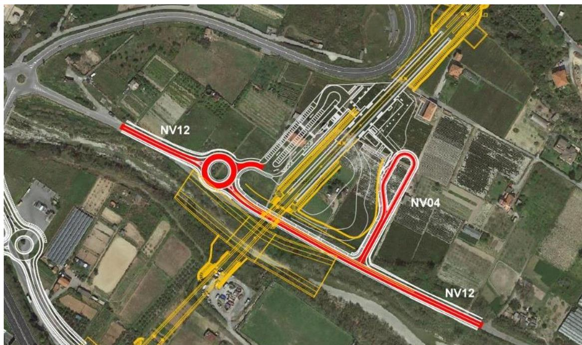
**Figura 21 – Interventi NV04 e NV12 (in rosso nell'immagine soprastante) di adeguamento della viabilità in corrispondenza della futura stazione di Borghetto S.Spirito. In giallo elementi già assentiti non oggetto di SIA (doc. IV0100D22RGSA0001001)**
