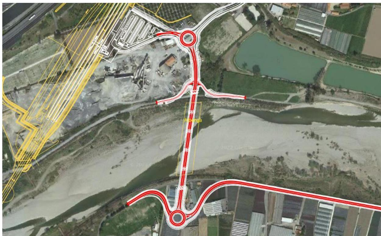
**Figura 40 – Nuova viabilità NVX6 (in rosso nell'immagine soprastante) con l'attraversamento in viadotto (IVX8) del torrente Arroscia. In giallo elementi già esistenti non oggetto di SIA (doc. IV0I00D22RGSA0001001)**
