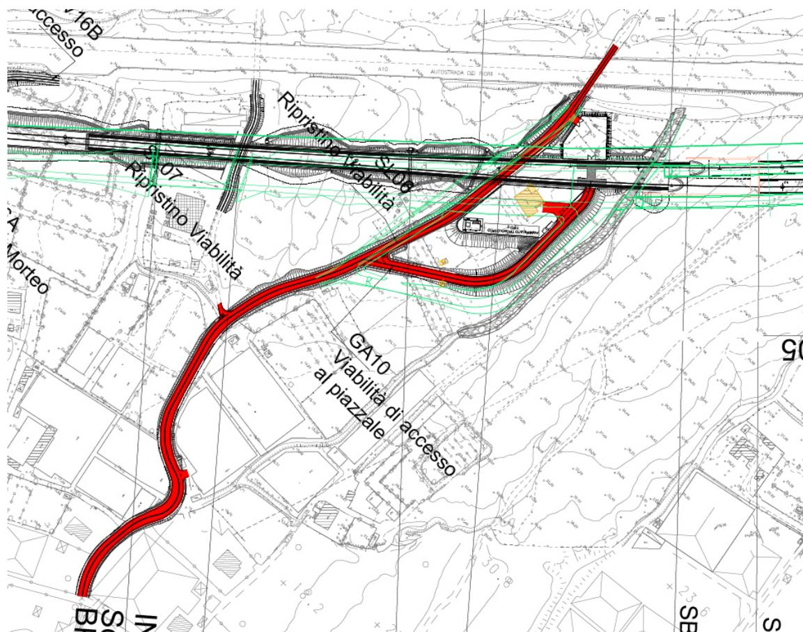
**Figura 28 – GA10 e SL06 – Confronto tra il P.P. 2003 (in verde) e il P.D. in esame (in rosso). In giallo elementi già assentiti non oggetto di SIA (doc. IV0100D22RGSA0001001)**
