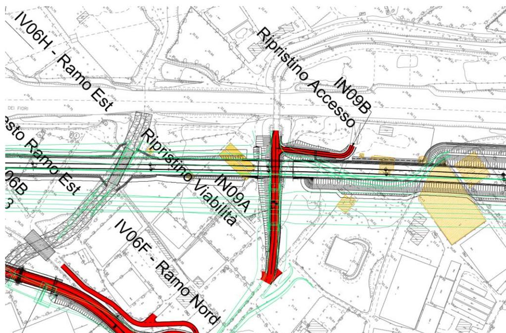
Figura 29 - IN09 (in rosso nell'immagine soprastante) – Adeguamento della Strada alla progressiva 83+192 ( in verde il precedente progetto). In giallo elementi già assentiti non oggetto di SIA (doc. IV0100D22RGSA0001001)
