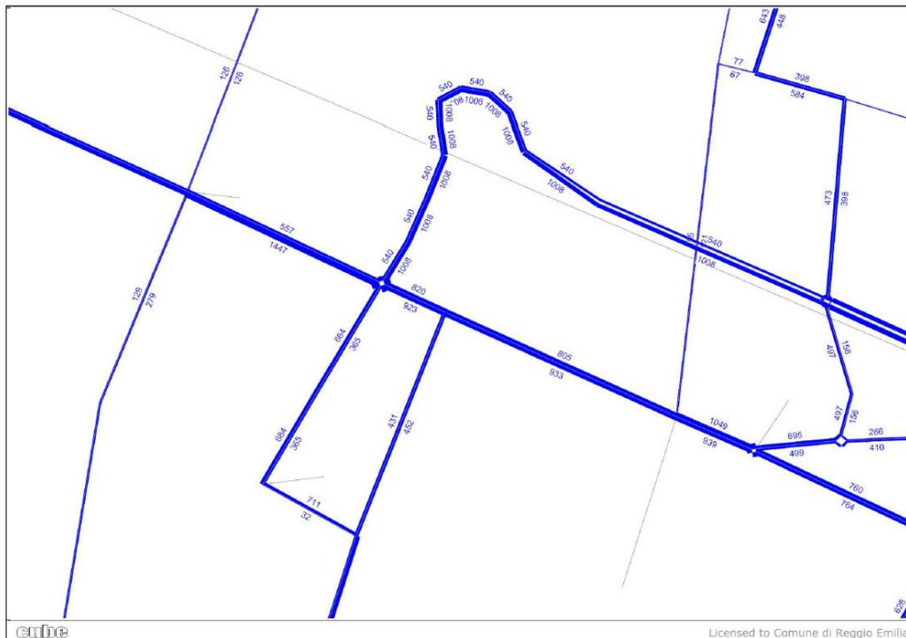
FIGURA 4.3-6 – SCENARIO 2027 CON ROTATORIA EMILIA/GORGANZA : FLUSSOGRAMMA VEICOLI EQ./ORA PUNTA DEL MATTINO NEL DETTAGLIO DEL NODO DI CORTE TEGGE (FIGURA ESTRATTA DA MODELLO CUBE)
