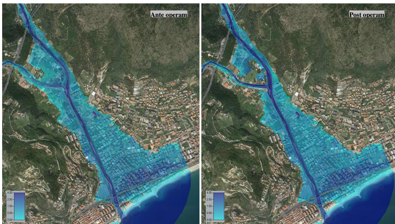
Figura 28: Modello numerico 2D, T. Maremola e Giustenice: confronto in termini di aree potenzialmente inondabili, ante operam (a sinistra) vs post operam (a destra), Tr = 200 anni.
