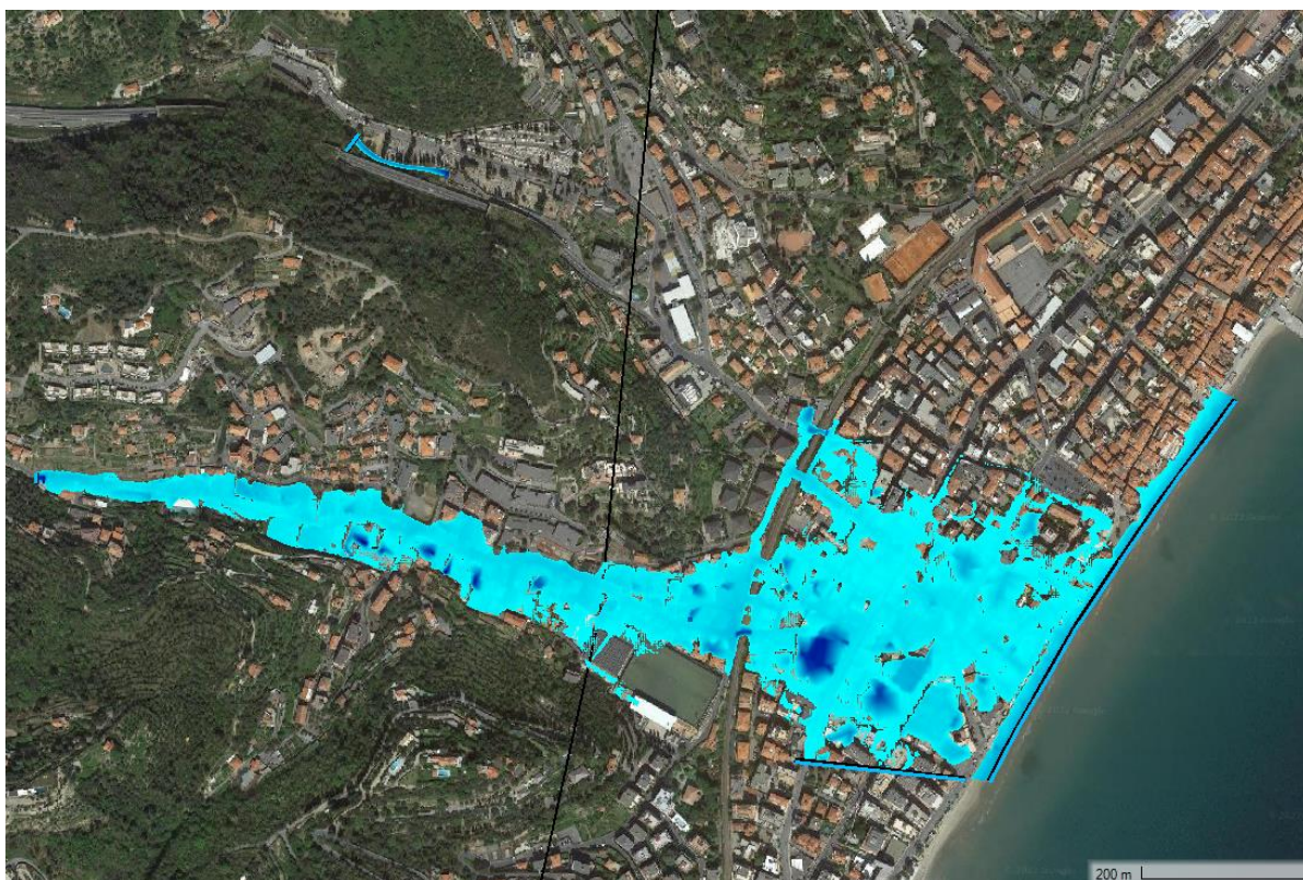
Figura 17: Confronto tra gli allagamenti ottenuti con il modello e quelli definiti dal PAI
