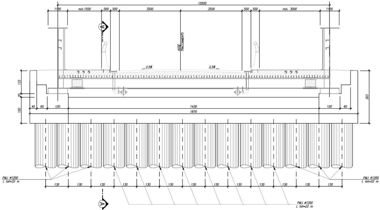
Figura 7 Sezione longitudinale Spalle (Sezione B-B)
