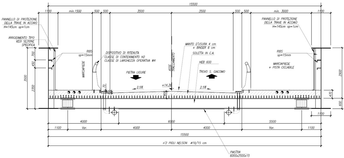
Figura 3 Sezione trasversale Impalcato (Sezione A-A)
