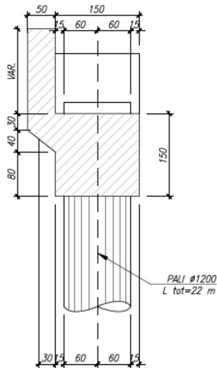
Figura 8 Sezione trasversale Spalle (Sezione A-A)
