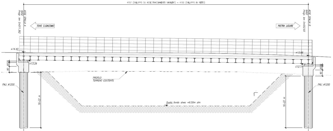
*Figura 4 Sezione longitudinale Impalcato (Sezione B-B)*
