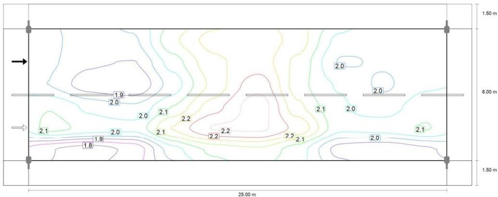
Osservatore 2: Valore di manutenzione luminanza con carreggiata asciutta [cd/m<sup>2</sup>] (Curve isolux)
