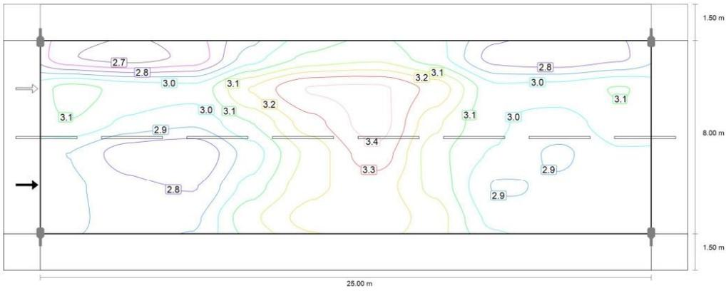
Osservatore 1: Luminanza per nuova installazione [cd/m<sup>2</sup>] (Curve isolux)
