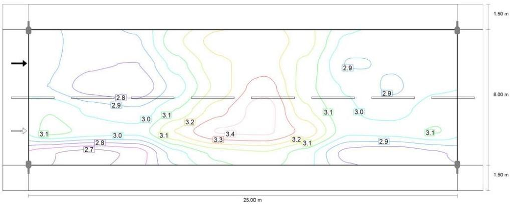
Osservatore 2: Luminanza per nuova installazione [cd/m<sup>2</sup>] (Curve isolux)
