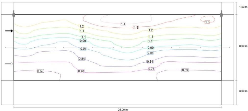
Osservatore 2: Valore di manutenzione luminanza con carreggiata asciutta [cd/m<sup>2</sup>] (Curve isolux)
