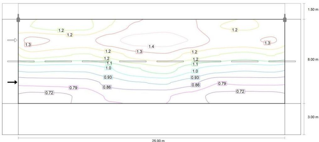
Osservatore 1: Valore di manutenzione luminanza con carreggiata asciutta [ $cd/m^2$ ] (Curve isolux)
