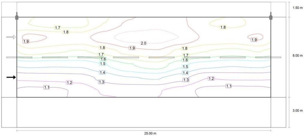
Osservatore 1: Luminanza per nuova installazione [cd/m<sup>2</sup>] (Curve isolux)
